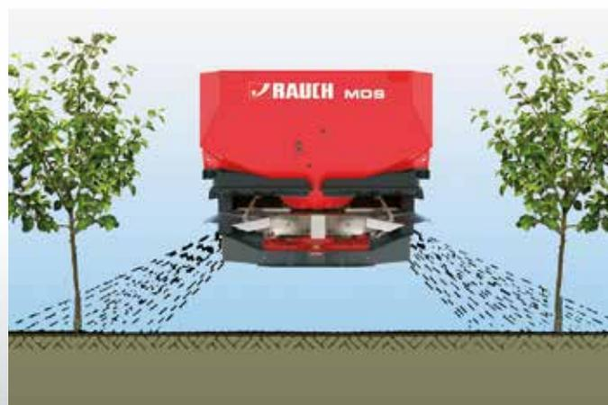
Modo de acción del dispositivo de distribución en filas RV 2M
