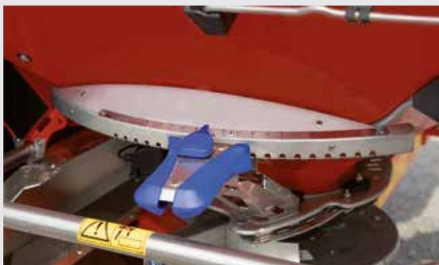
Die gut lesbare, mengenproportionale DfC-Skala, einzigartig von RAUCH, ermöglicht die zuverlässige Mengenkorrektur nach der Abdrehrprobe.
