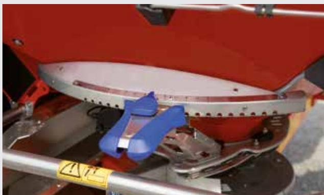
Bien lisible et proportionnelle, l'échelle DfC, une fonction unique à RAUCH, assure la fiabilité de correction du dosage après le contrôle de débit
