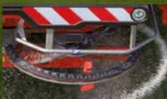
**Contrôle :** AXMAT duo contrôle et règle le schéma d'épandage avec l'assistance d'un radar
