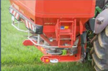
**AXIS H** - épandage en bordure à droite et à gauche par réglage du régime et du point de chute
