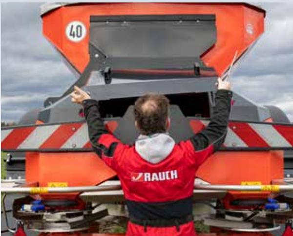
Para poder limpiar cómodamente la máquina, es posible desmontar la cubierta del esparcidor
