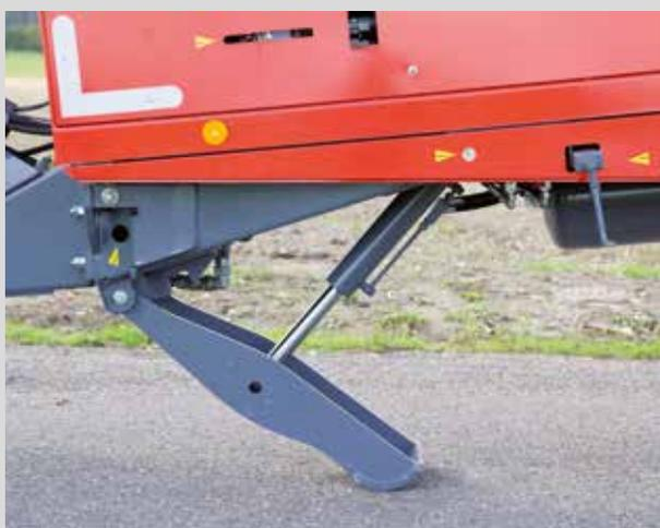
El pie de soporte hidráulico garantiza una estabilización rápida y fiable
