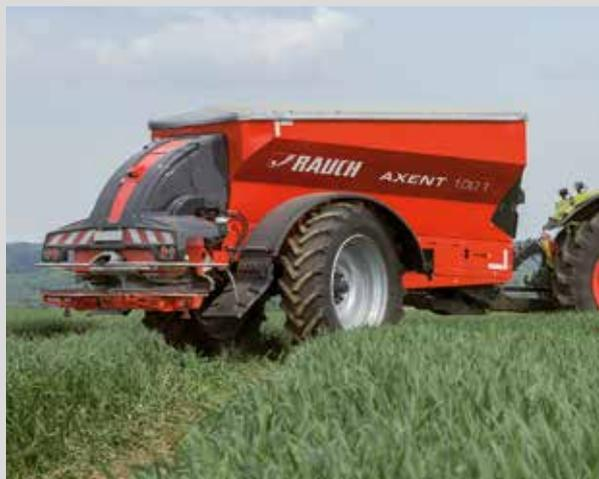
El equipamiento opcional incluye un eje de dirección (dirección del eje de rueda)
