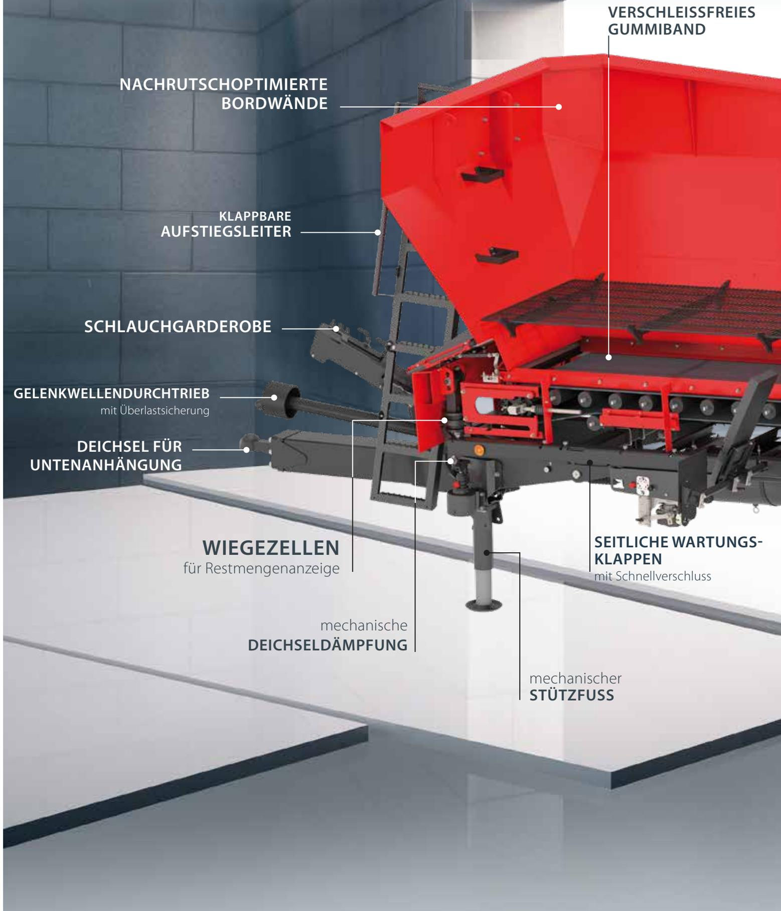
AXENT 90.1 ist die perfekte Kombination aus Schlagkraft, geringem Bodendruck und maximaler Streupräzision. Die Potenziale von AXENT 100.1 wurden hier konsequent in einer optimierten Preisklasse umgesetzt. Durch die angebaute AXIS Streutechnik nutzen Sie alle RAUCH-Vorteile in einem Zug: EMC-Dosierautomatik, GPS-Control, VariSpread und OptiPoint, gepaart mit einem einfachen Gelenkwelldurchtrieb mit Überlastschutz.
