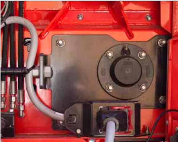
Abgedichtete Bandwellenlagerung und Schnellkuppler für die Streuwerks-Elektronik
