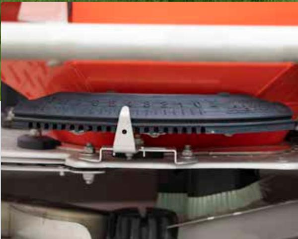
Hoher Bedienkomfort durch eine elektrische Aufgabepunktverstellung für eine stufenlose Teilbreiteneinstellung (Optional)
