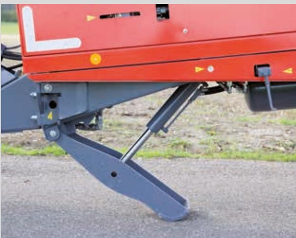
Der hydraulische Stützfuß sorgt für rasche und zuverlässige Stabilisierung
