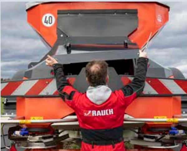
Für eine komfortable Reinigung der Maschine kann die Abdeckung des Streuwerks abgenommen werden
