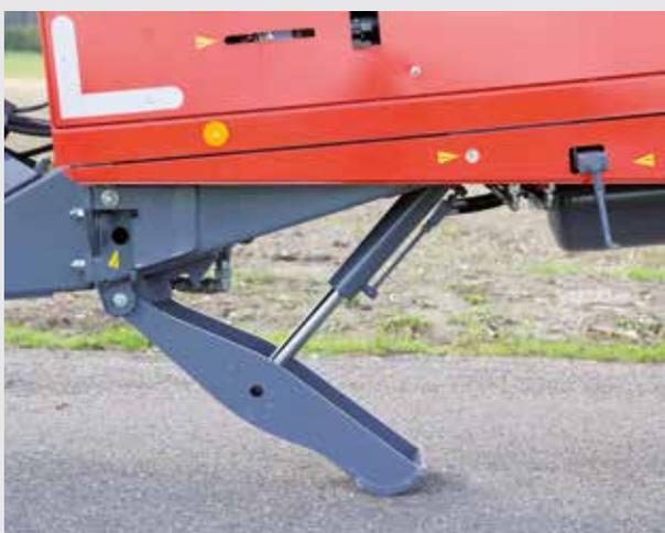
La béquille hydraulique assure une stabilisation rapide et fiable
