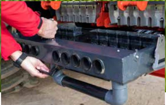
Einfaches Wegschwenken der Injektorkassette
