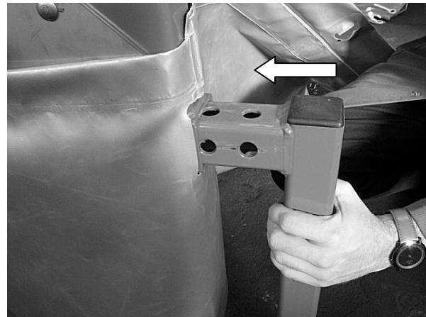
9. Visser la bâche avec le bouton étoilé (3) aux supports montés sur le tube de châssis. (voir fig.)
