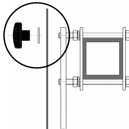
10. Retirer la béquille **gauche** (vu dans le sens de la marche pour un montage arrière) et la repousser de nouveau à travers **l'ouverture 2** de la bâche dans le distributeur.
