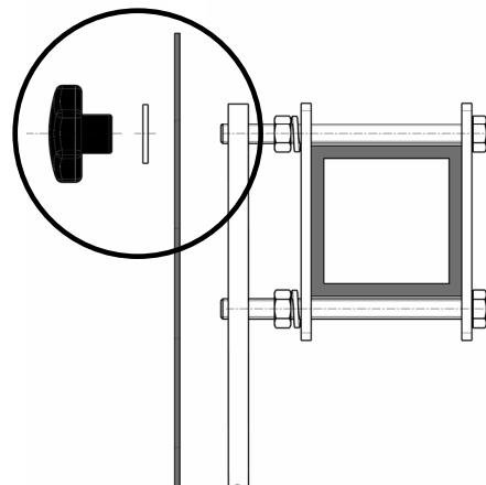
10. Ziehen Sie den **linken** anbauseitigen Abstellfuß (in Fahrtrichtung, bei Heckanbau) heraus und schieben Sie ihn wieder durch die **Öffnung 2** der Plane in den Streuer.
