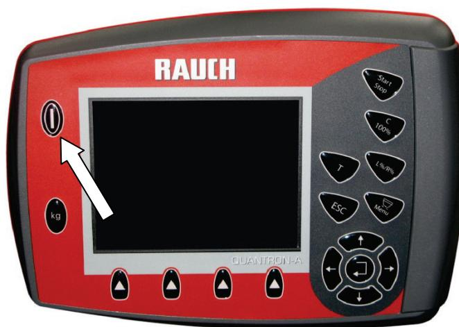
12.10. Odpojte jednotku QUANTRON-A od elektrického napájení a od rozmetadla.
