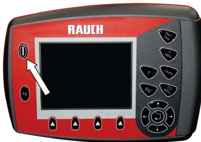
12.10. **QUANTRON-A** von der Spannungsversorgung und vom Streuer **trennen**.
