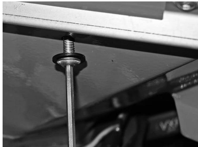
**4.21 Machine avec écrou à sertir dans le récipient :**
