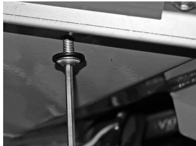
**4.21 Maschine mit Einnietmutter im Behälter:**
