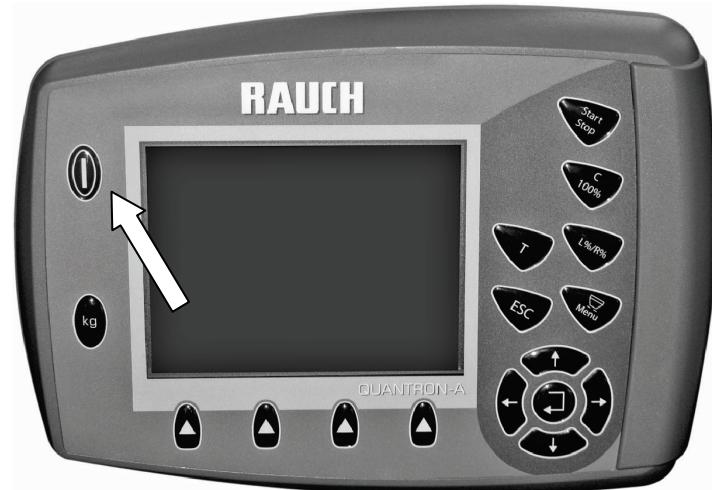
11.9. QUANTRON-A von der Spannungsversorgung trennen.
