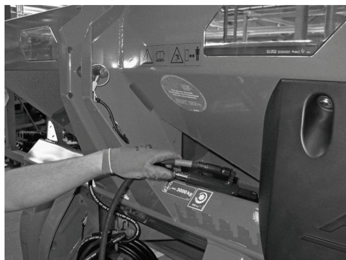
03.12. Démonter les deux consoles et retirer les vis.
