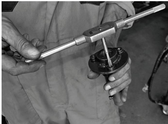
3.5 Roerwerkas **vanbinnen** invetten, inclusief het boorgat voor de schroefdraadstift.
