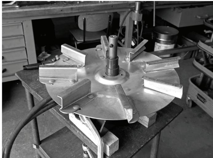
3.10 Připravte si tři šrouby se samopojistkou a podložkami pro rozmetací disk.
