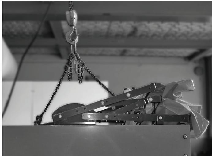
4.12 Axiale speling en afstand van het roerwerk ten opzichte van de bodem controleren.
