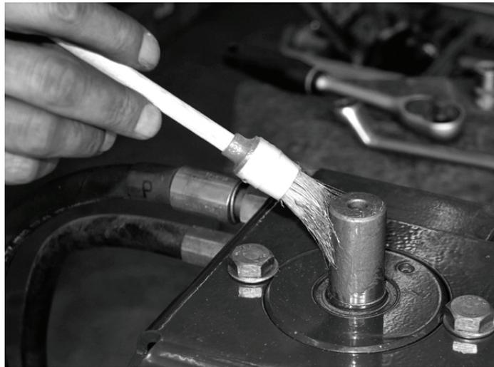
3.4 Die drei Gewinde für die Wurfscheibenaufnahme an der neuen Rührwerkswelle nachschneiden.
