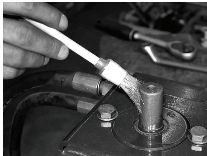
3.4 Araser le filetage des trois trous du support du disque d'épandage sur le nouvel arbre agitateur.
