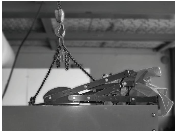
4.12 Contrôler le jeu axial et la distance de l'agitateur par rapport au fond de trémie.
