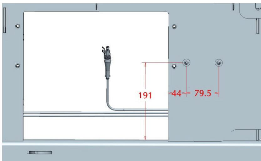
Befestigen Sie den Gußverteiler **an der Innenseite** mit den mitgelieferten Normteilen
