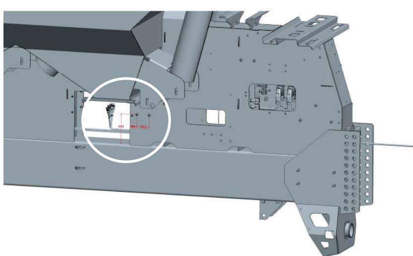
Zur Befestigung des Gußverteilers bohren sie Löcher Ø7mm am Rahmen. Verwenden Sie folgende Maßangaben.
