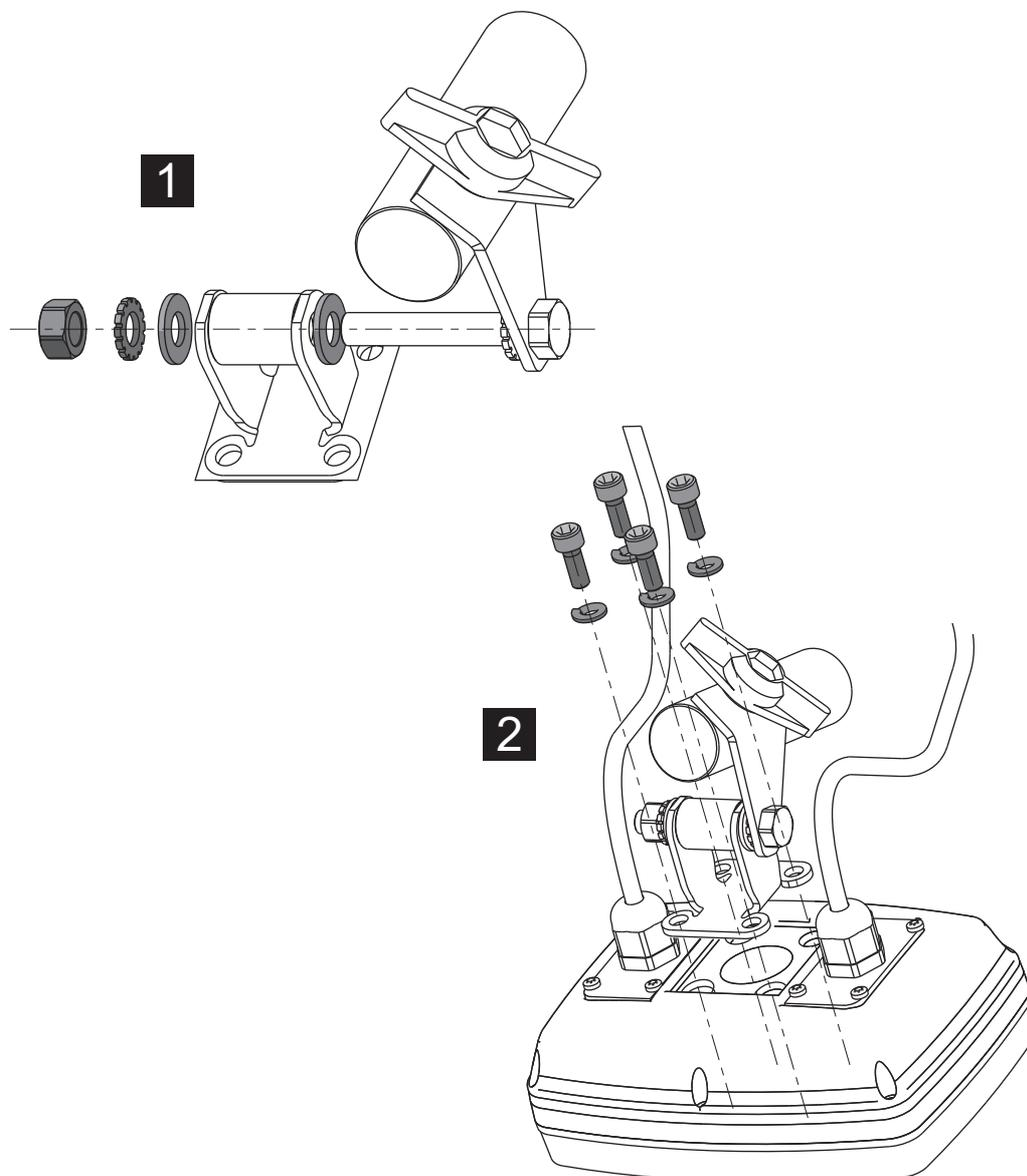
**Figura 3.2:** Montaggio supporto dell'apparecchio
