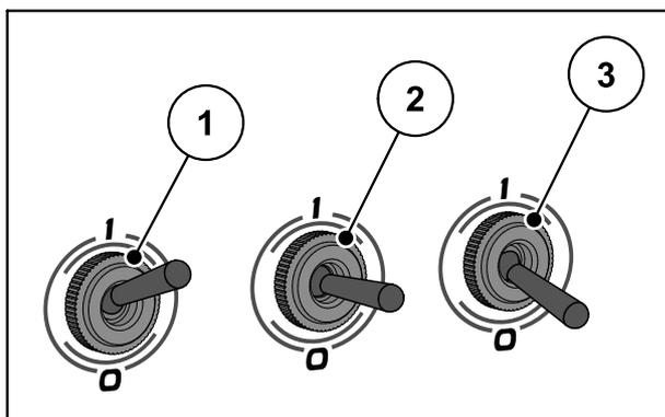
**Figura 4.1:** Posizione interruttore a levetta stato di commutazione
