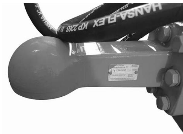
**Bild 9.15:** Kugelkopfkupplung
