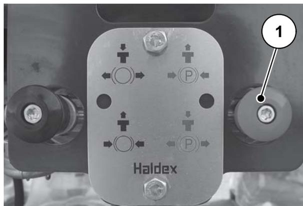
**Bild 7.1:** Feststellbremse lösen
