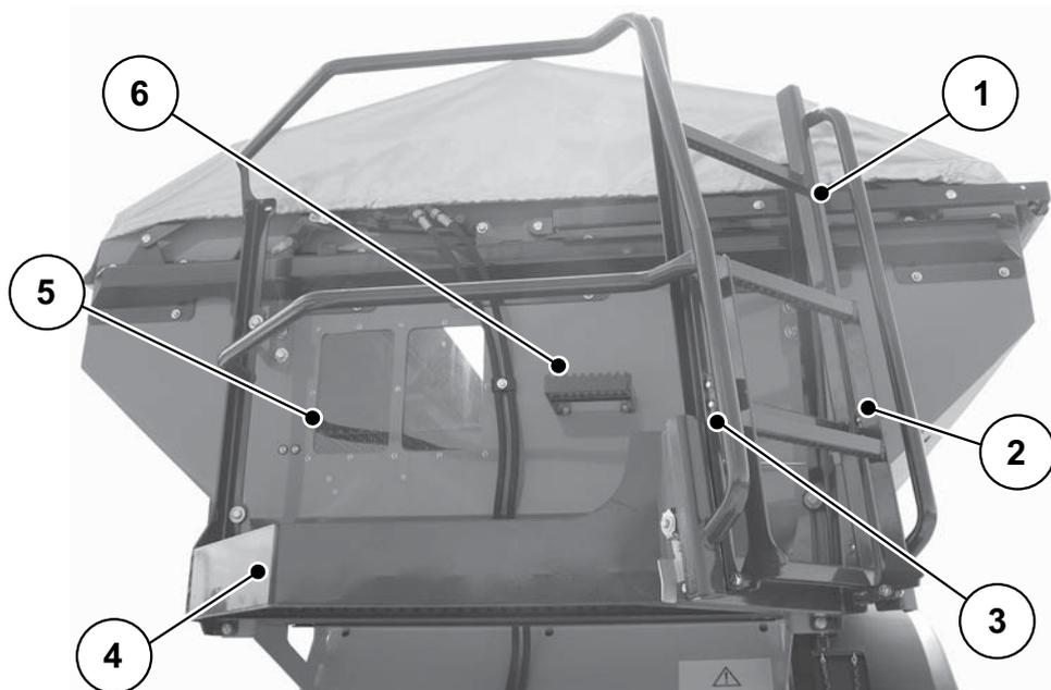
**Bild 6.16:** Füllstandskontrolle
