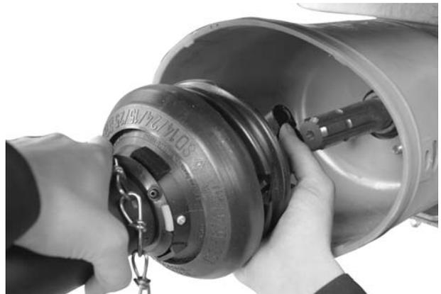
**Bild 6.1:** Gelenkwelle auf Getriebezapfen aufstecken
