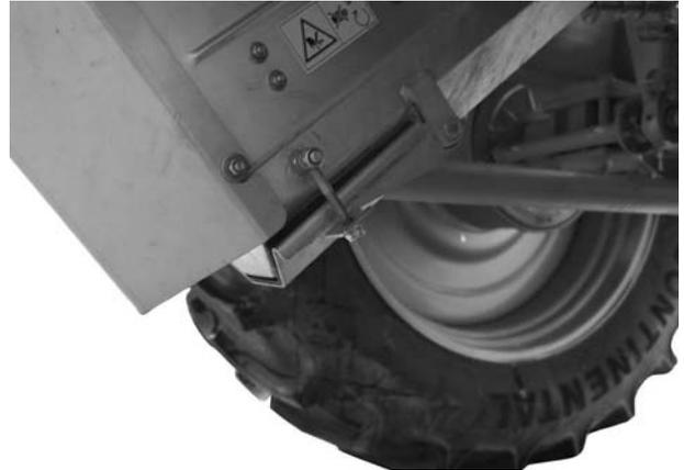
**Bild 7.3:** Entleerungsklappe unter Behälter
