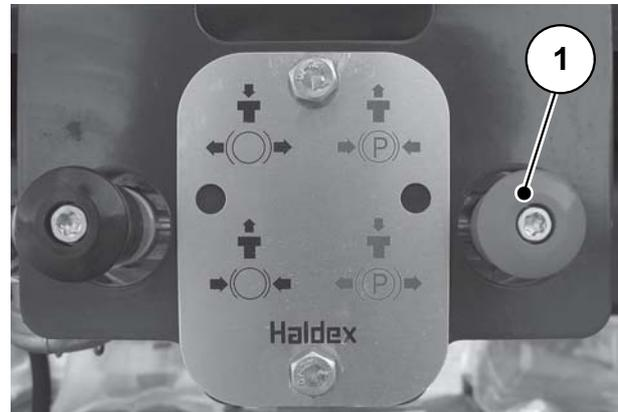
**Bild 7.6:** Feststellbremse anziehen
