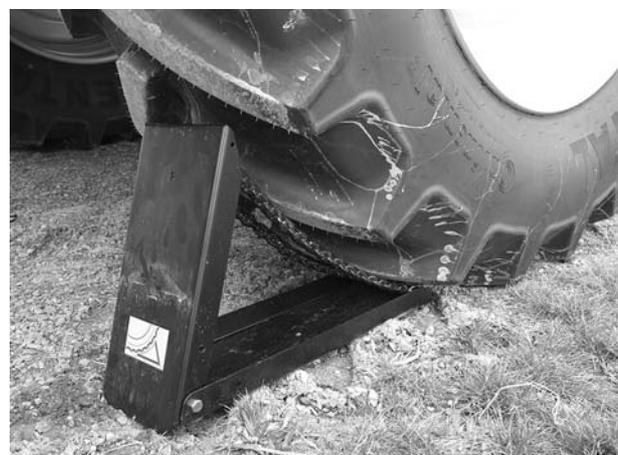
**Bild 7.8:** Unterlegkeil positionieren
