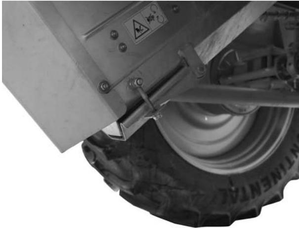
**Bild 6.15:** Schnellentleerungsklappe
