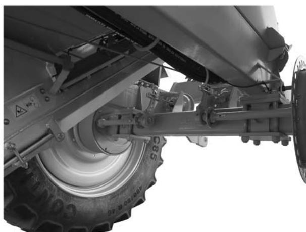
**Bild 9.10:** Bremsgestänge
