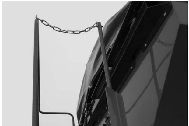
**Bild 6.19:** Sicherungskette gegen unbefugtes Besteigen der Plattform
