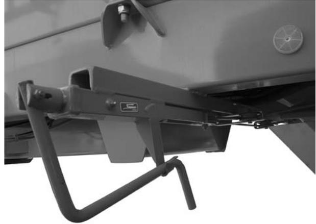
**Bild 9.11:** Handbremse
