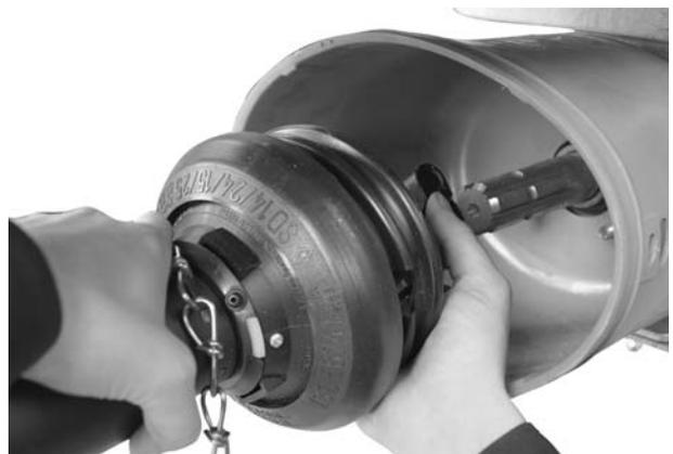
**Bild 6.1:** Gelenkwelle auf Getriebezapfen aufstecken
