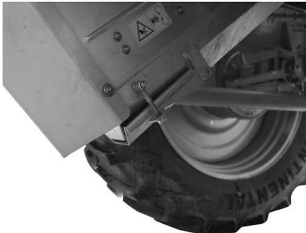
**Bild 6.16:** Schnellentleerungsklappe
