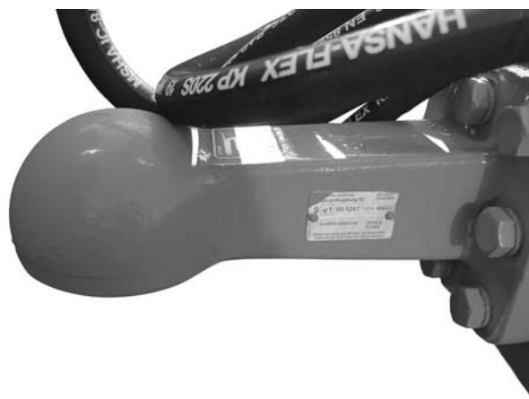
**Bild 9.9:** Kugelkopfkupplung
