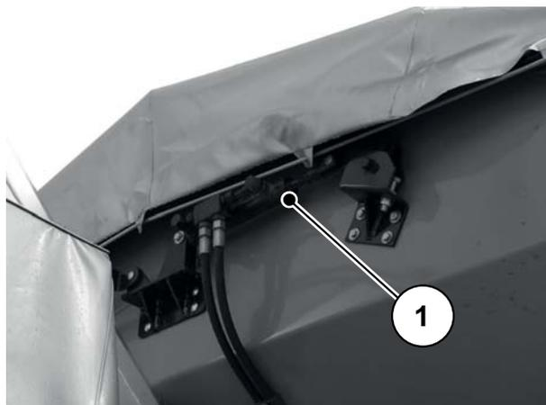
**Bild 9.5:** Hydraulikzylinder Abdeckplane - Hinten
