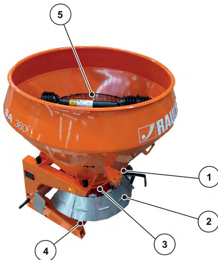
Abb. 4: Lage der Schutzeinrichtungen sowie Warn- und Instruktionshinweise
