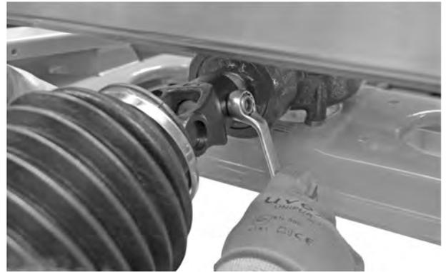
Abb. 15: Gelenkwelle verbinden
