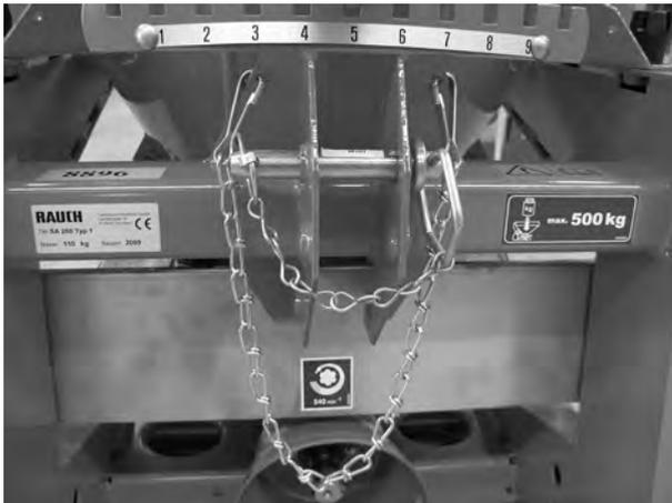
Abb. 18: gesicherter Bolzen
