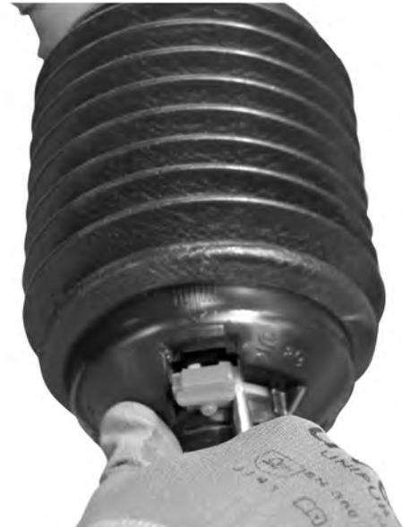
*Abb. 13: Gelenkwellenschutz öffnen*
