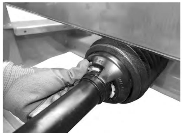
Abb. 17: Gelenkwellschutz sichern
