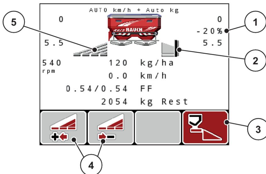
Ilust. 52: Pantalla de funcionamiento de una anchura parcial izquierda, lado de dispersión límite derecho
