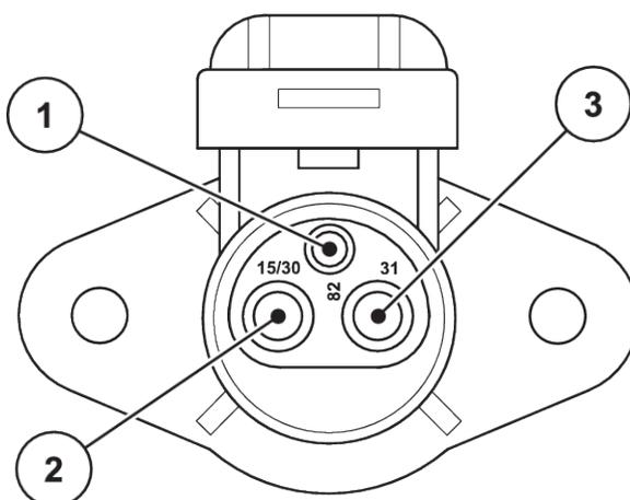
Ilust. 9: Asignación de PIN en la caja de conexión de corriente
