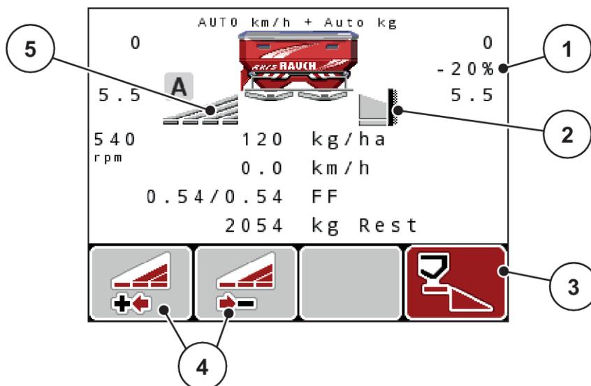
Ilust. 53: Pantalla de funcionamiento de una anchura parcial izquierda, lado de dispersión límite derecho
