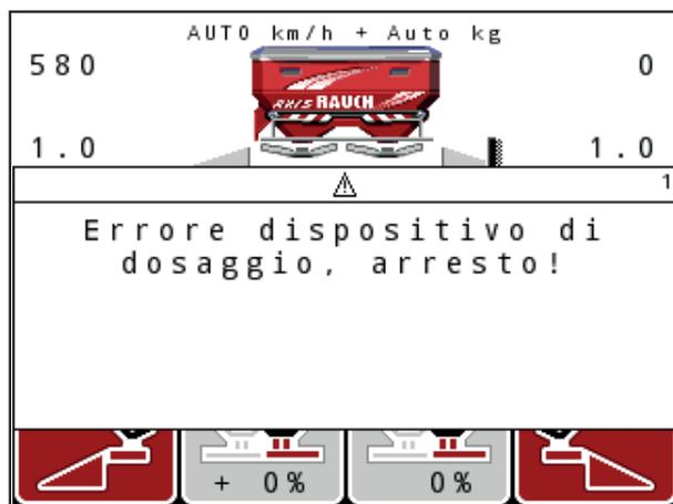
**Figura 6.1:** Messaggio di allarme (esempio dispositivo dosatore)
