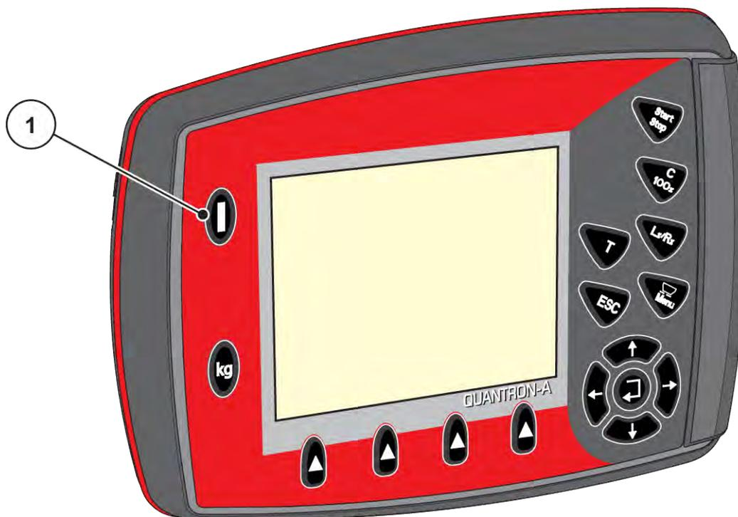
Abb. 16: Bedieneinheit einschalten
