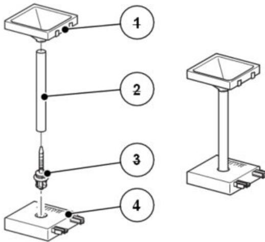
Abb. 1: Zusammenbau Messrohre
