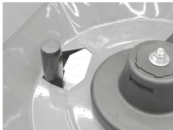
Fig. 70: Bolțul de la bara de cuplare inferioară în deschiderea de dozare
