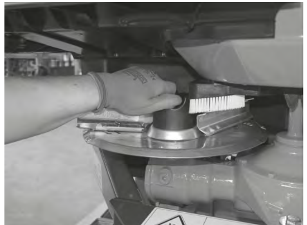
Рис. 38: Закручивание колпачковой гайки
