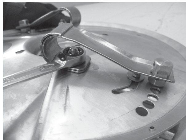
Рис. 94: Закрепление плоской пружины
