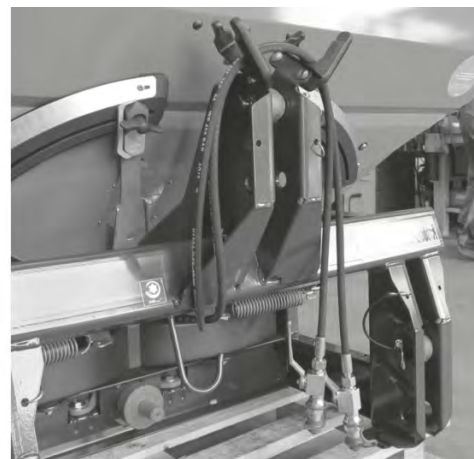
Рис. 62: Место размещения карданного вала, кабелей и гидравлических шлангов
