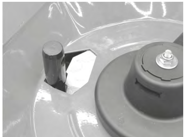
Рис. 68: Болт нижней тяги в дозировочном отверстии
