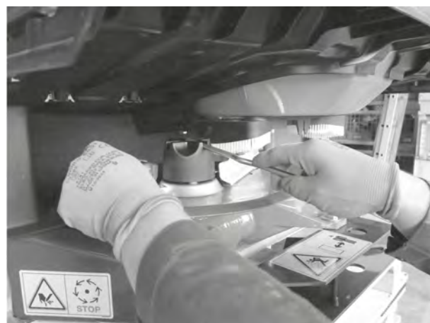
Рис. 76: Отвинчивание колпачковой гайки
