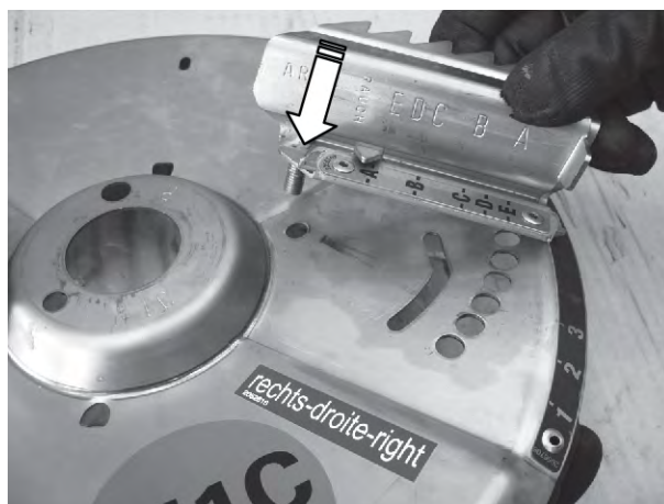
Рис. 90: Монтаж основной лопатки
