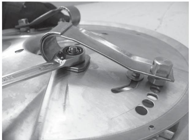
Рисунок 12.22: Удаление винтов
