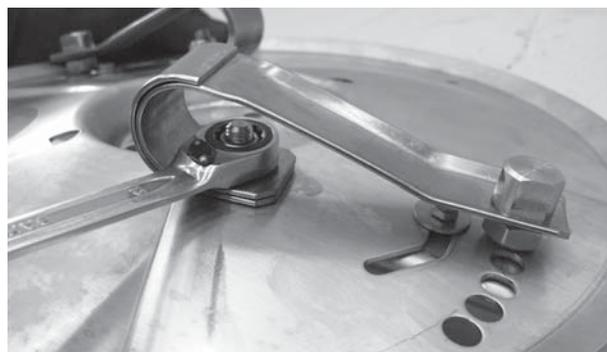
**Рисунок 12.30:** Закрепление плоской пружины
