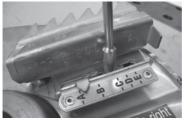
**Рисунок 12.27:** Лопатки на разбрасывающем диске
