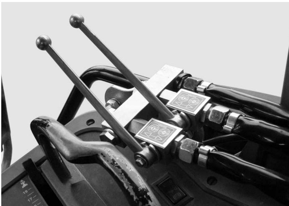
**Рисунок 7.12:** Управление заслонками с помощью двухходового блока
