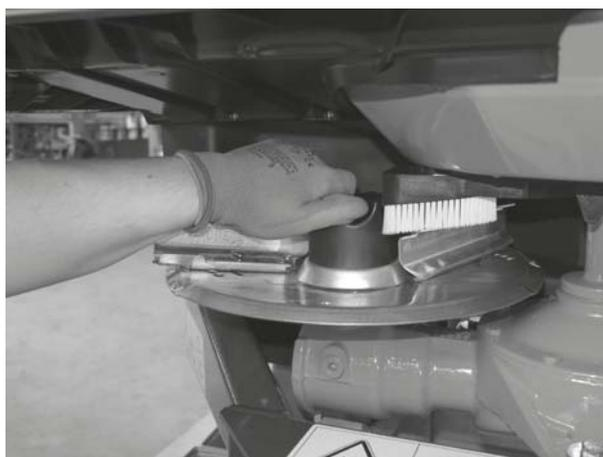
**Рисунок 9.8:** Привинчивание колпачковой гайки
