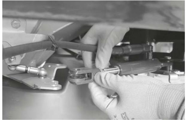
Рисунок 12.8: Извлеките гидроцилиндр
