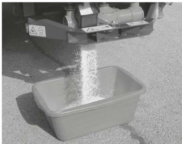
**Рисунок 9.7:** Выполнение установки нормы внесения
