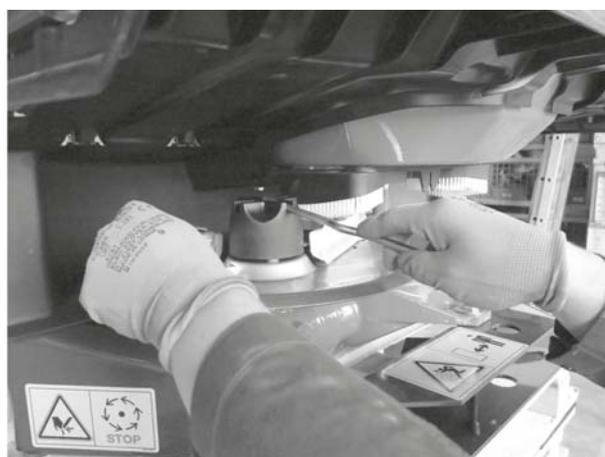
**Рисунок 9.5:** Ослабление колпачковой гайки
