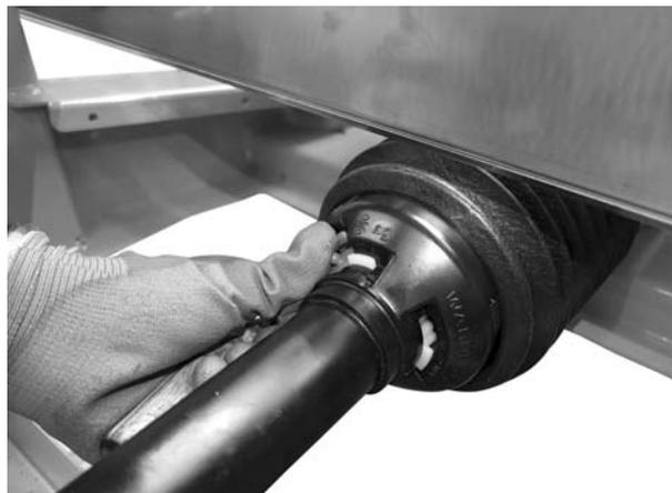
**Рисунок 7.5:** Фиксация защитного кожуха карданного вала
