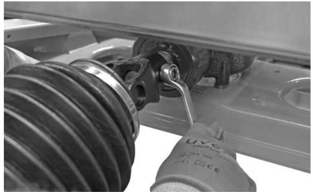
**Рисунок 7.3:** Соединение карданного вала
