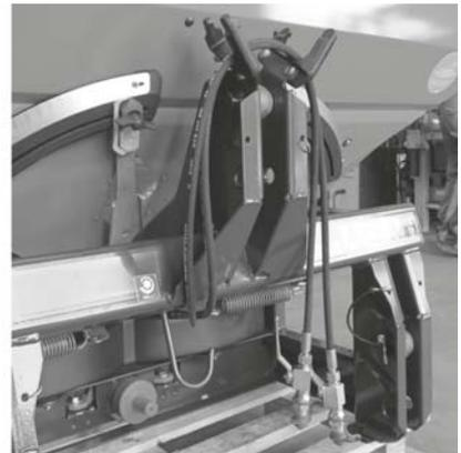
Рисунок 7.14: Держатель для карданного вала и гидравлических шлангов
