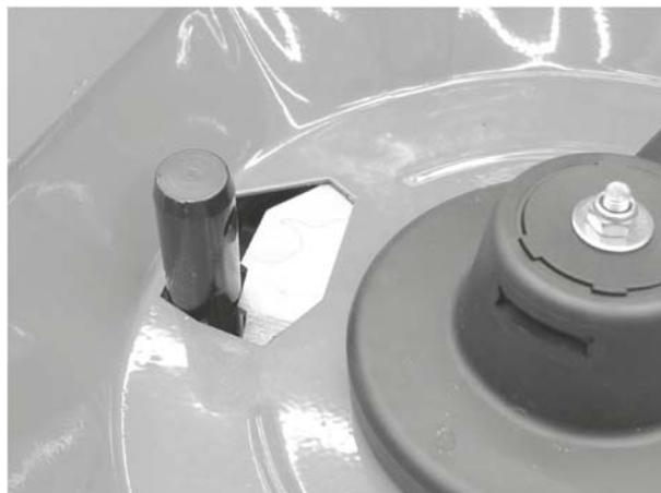
**Рисунок 12.5:** Болт нижней тяги в дозирующем отверстии
