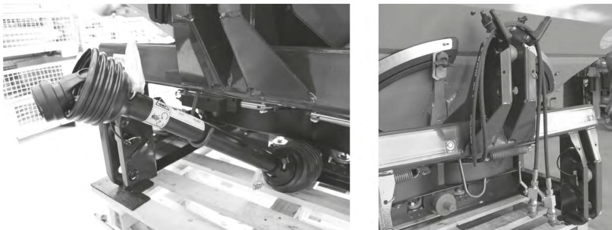
*Ilust. 64: Sujeción del eje articulado, de los cables y de las mangueras hidráulicas*
