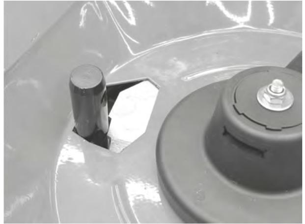
*Ilust. 70: Perno de brazo inferior en la abertura de dosificación*
