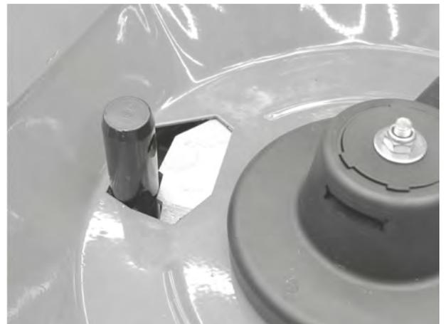
*Ilust. 68: Perno de brazo inferior en la abertura de dosificación*
