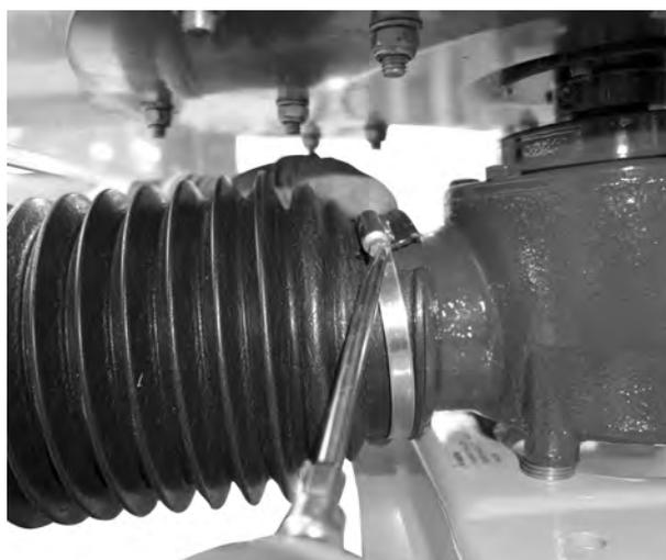
*Ilust. 14: Colocar la protección del eje articulado*
