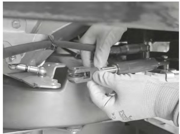
*Ilust. 71: Extraer el cilindro hidráulico*
