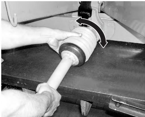
*Ilust. 20: Colocar la protección del eje articulado*
