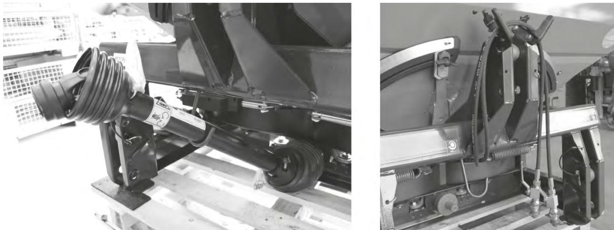
*Ilust. 62: Sujeción del eje articulado, de los cables y de las mangueras hidráulicas*
