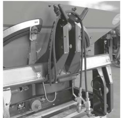
**Imagen 7.14:** Colocación del eje articulado y de los latiguillos hidráulicos
