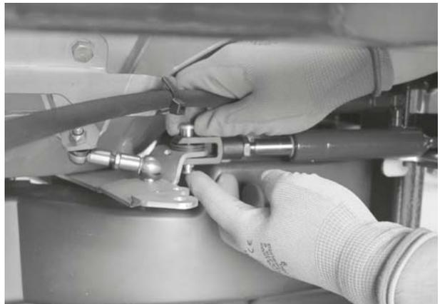
6. Separar la corredera de dosificación y el cilindro hidráulico o eléctrico
