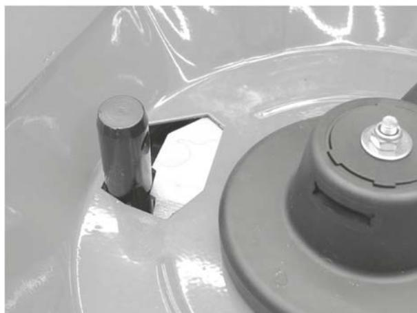
**Imagen 12.5:** Perno de brazo inferior de enganche en el orificio de dosificación
