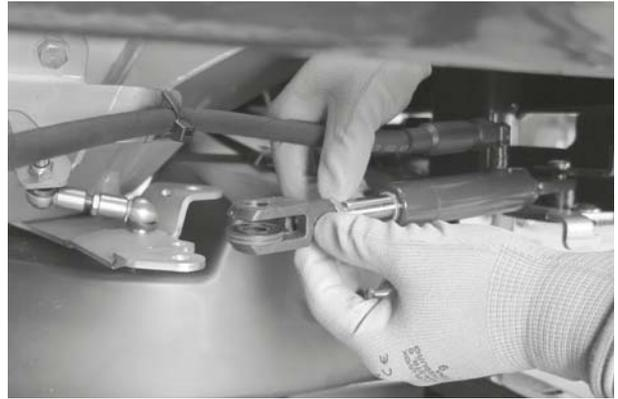
Imagen 12.8: Extraer cilindro hidráulico
