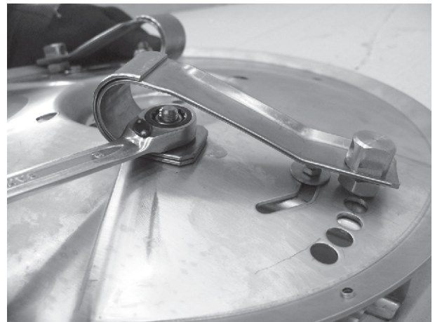
Afb. 96: Bevestiging van de platte veer
