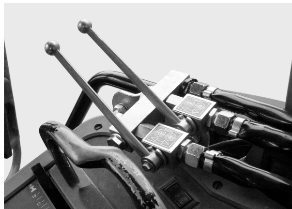
Afb. 30: Schuifbediening van de tweewegseenheid
