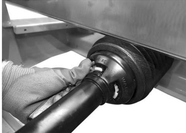
**Figura 7.5:** Fissare la protezione dell'albero cardanico
