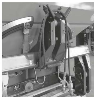
Figura 7.14: Posa dell'albero cardanico e dei tubi idraulici
