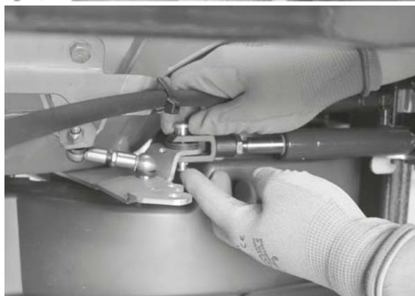
6. Staccare il dosatore dal cilindro idraulico/cilindro elettrico.
