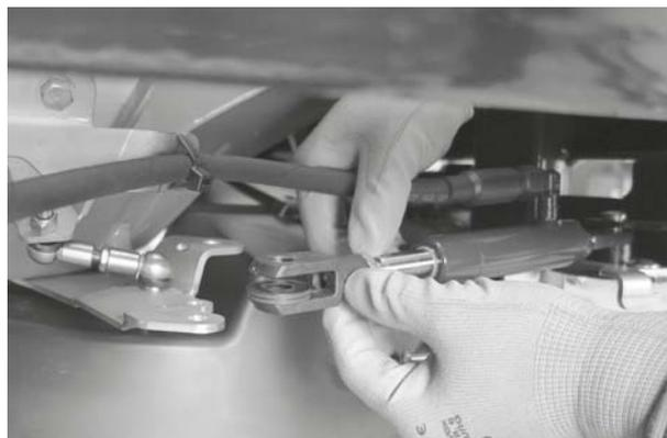
Figura 12.8: Estrarre il cilindro idraulico
