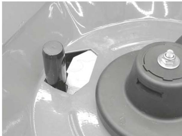
**Figura 12.5:** Perno del braccio inferiore nell'apertura di dosaggio
