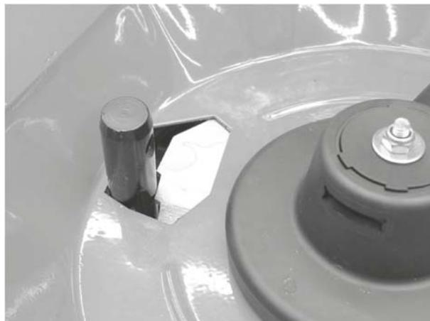
**Figure 12.5** : Axe de bras inférieur d'attelage dans la trappe
