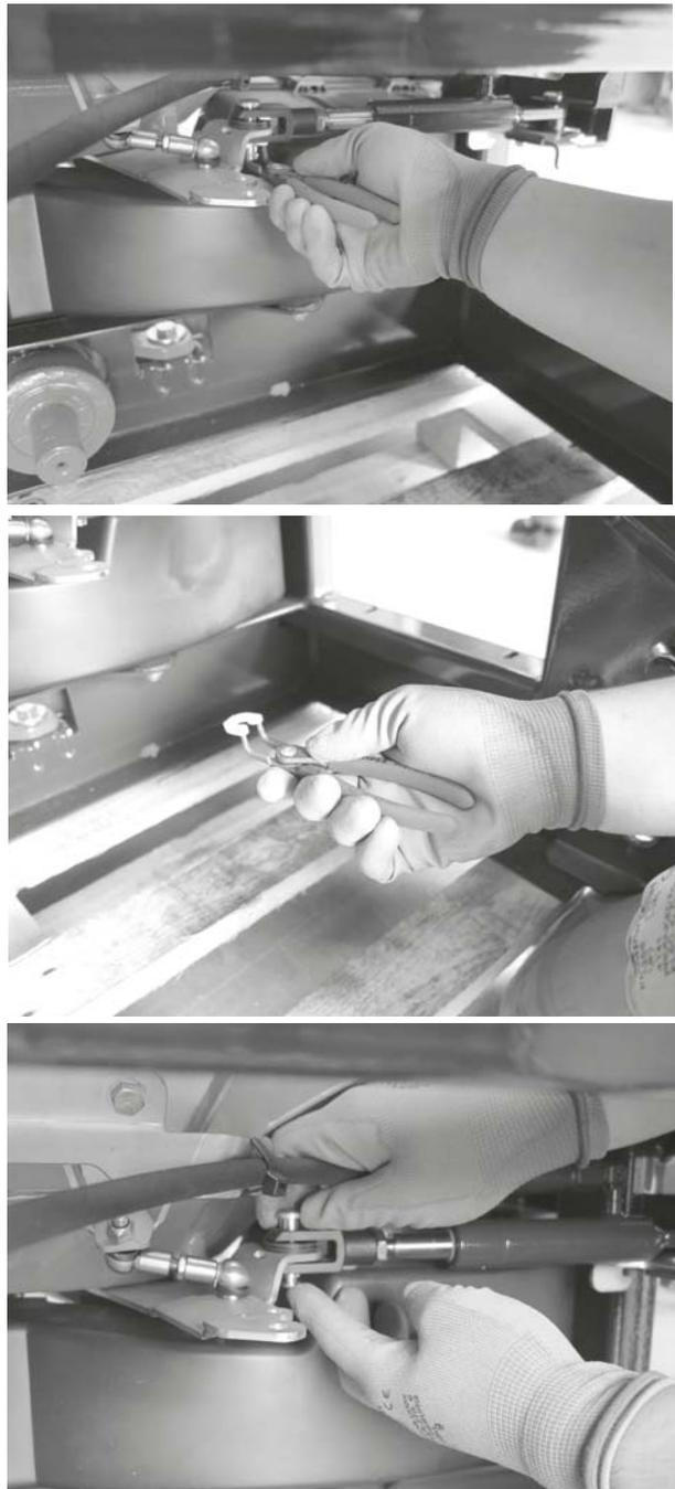
6. Séparer la vanne de dosage et le vérin hydraulique/électrique.
