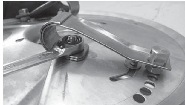
**Figure 12.30 :** Fixation du ressort plat
