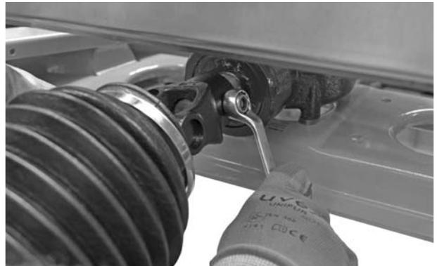
**Figure 7.3 :** Raccorder l'arbre de transmission
