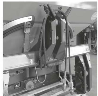
Figure 7.14 : Rangement de l'arbre de transmission et des tuyaux hydrauliques
