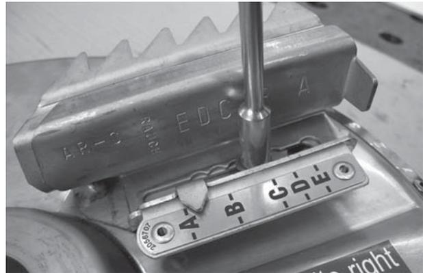
**Figure 12.27 :** Palette sur le disque d'épandage
