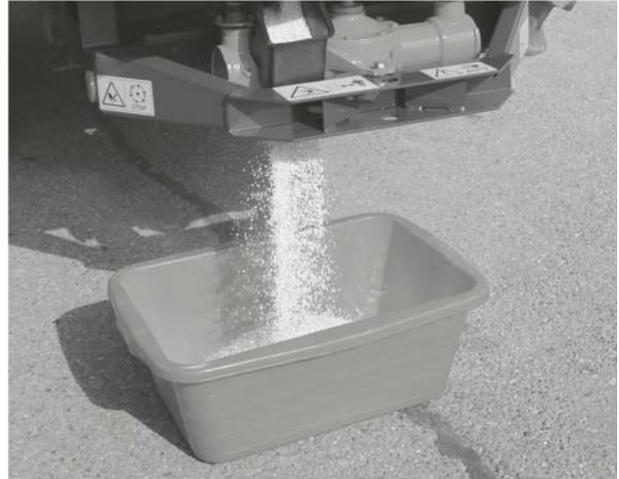
6. Placer le bac récupérateur sous l'écoulement gauche.
