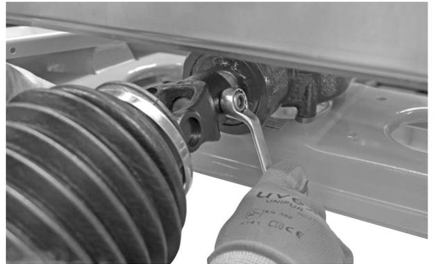
*Abb. 13: Gelenkwelle verbinden*
