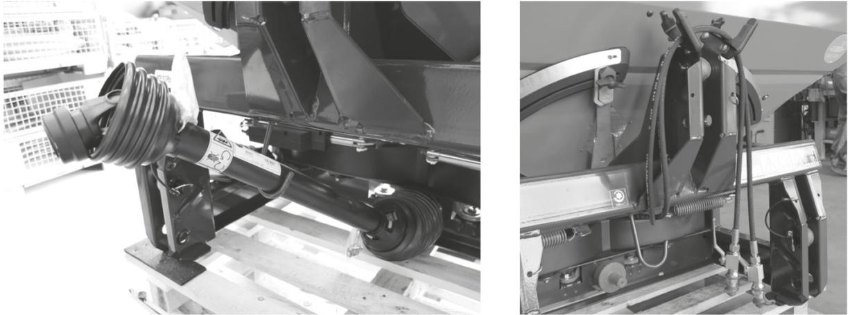
*Abb. 62: Ablage der Gelenkwelle, Ablage der Kabel und Hydraulikschläuche*
