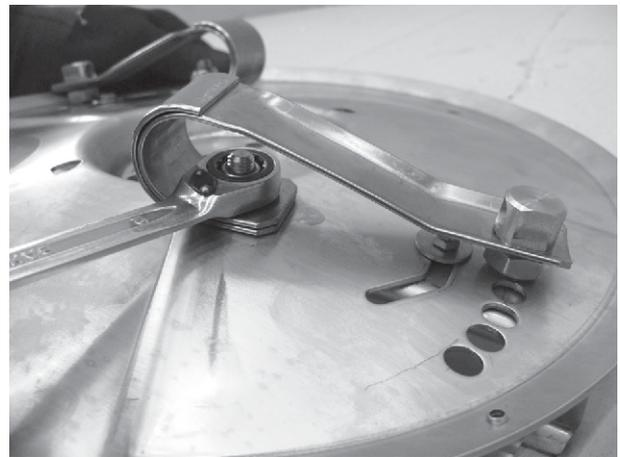
Abb. 94: Befestigung der Flachfeder
