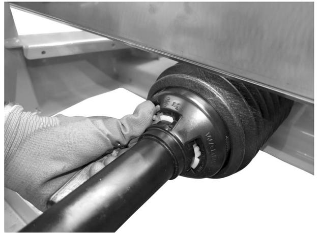
*Abb. 15: Gelenkwellenschutz sichern*
