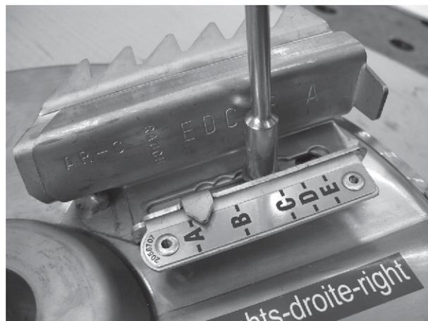
Abb. 91: Wurfflügel an der Wurfscheibe
