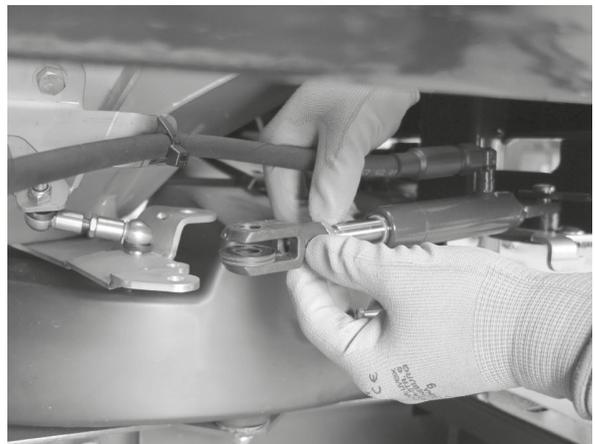
Abb. 71: Hydraulikzylinder herausziehen
