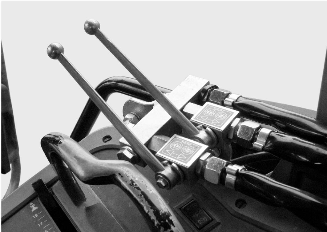
Abb. 28: Schieberbetätigung der Zwei-Wege-Einheit
