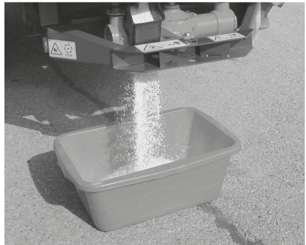
*Abb. 37: Abdrehprobe durchführen*
