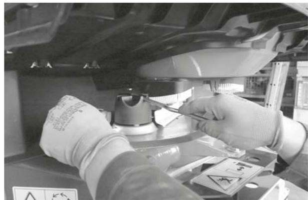
**Bild 12.13:** Hutmutter lösen
