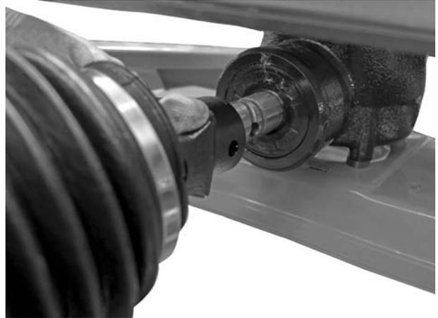
**Bild 7.2:** Gelenkwelle auf Getriebezapfen aufstecken
