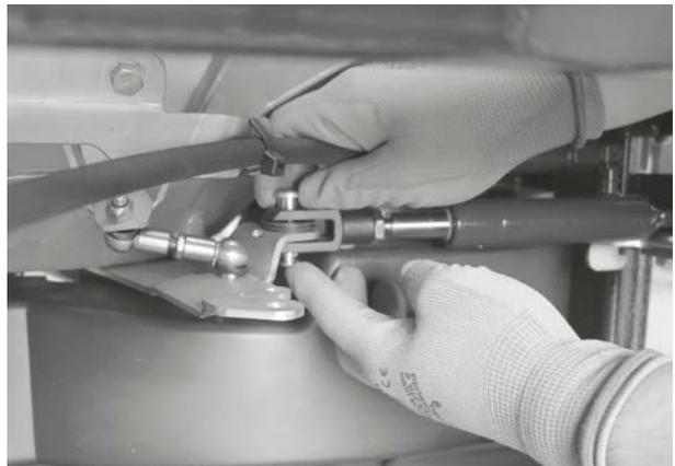
6. Dosierschieber und Hydraulik-/ Elektrozyylinder trennen.
