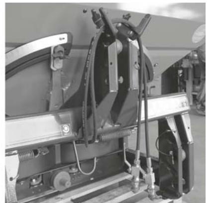
**Bild 7.14:** Ablage der Gelenkwelle und der Hydraulikschläuche
