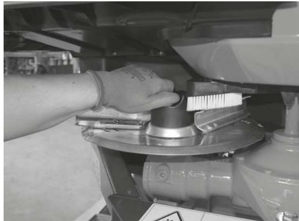
**Bild 9.8:** Hutmutter verschrauben
