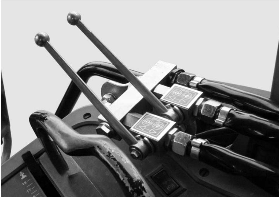
**Bild 7.12:** Schieberbetätigung der Zwei-Wege-Einheit
