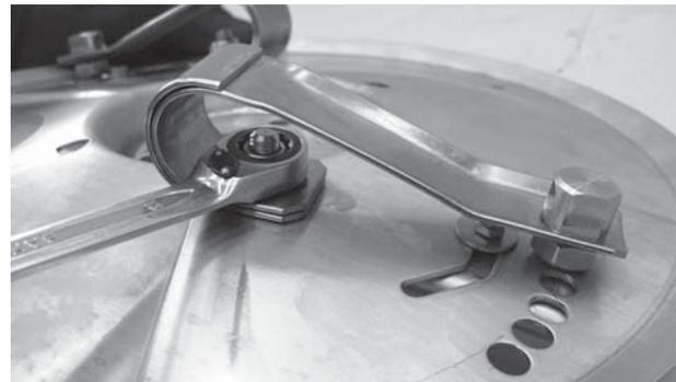
**Bild 12.30:** Befestigung der Flachfeder
