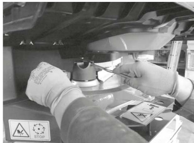
**Bild 9.5:** Hutmutter lösen
