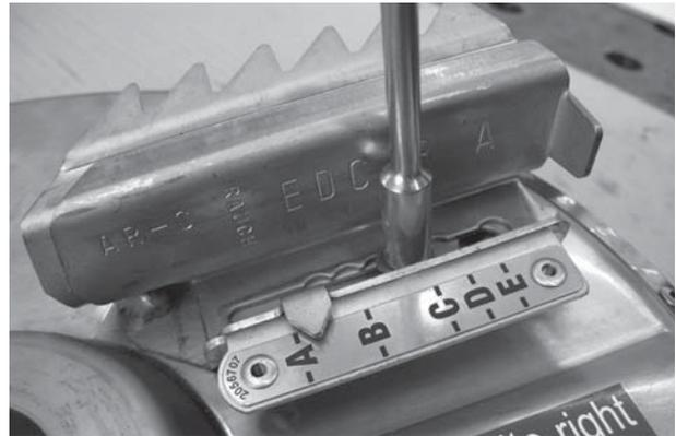
図 9.27: 散布ディスクの散布ブレード
