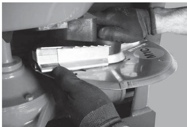
図 8.9: キャップナットを締める
