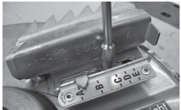
図 9.21: 散布ブレードの固定ポイント
