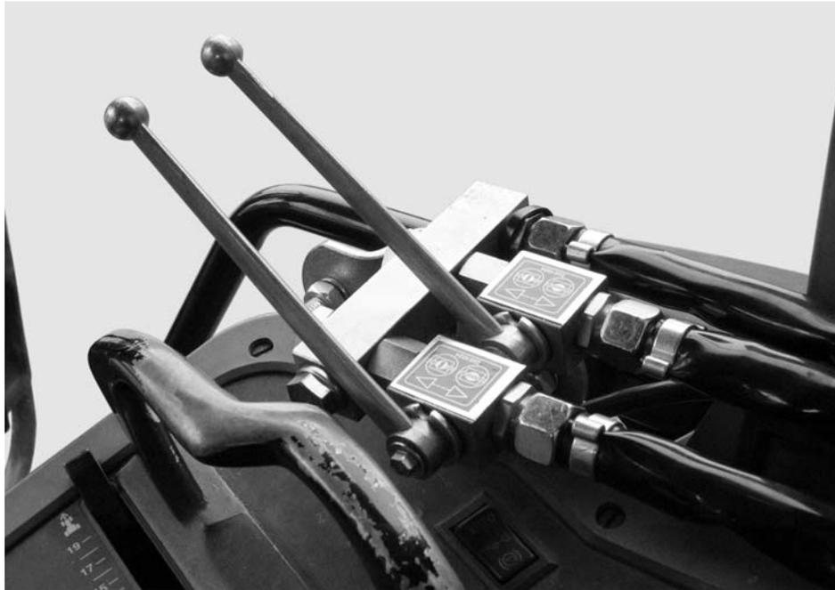
**рисунок 6.30:** Гидравлическое устройство управления заслонкой двухходового блока
