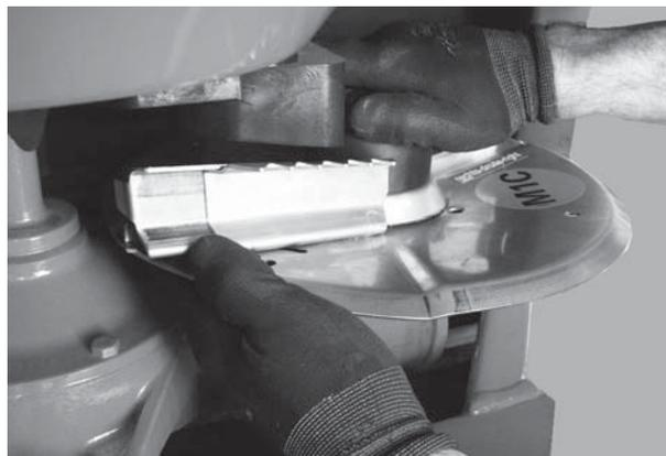
**рисунок 8.9:** Привинтить колпачковую гайку
