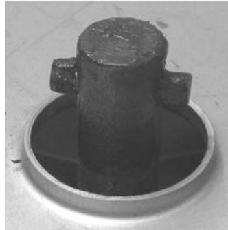
рисунки 6.5: Вал мешалки
