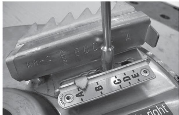
**рисунок 9.27:** Разбрасывающая лопатка на разбрасывающем диске
