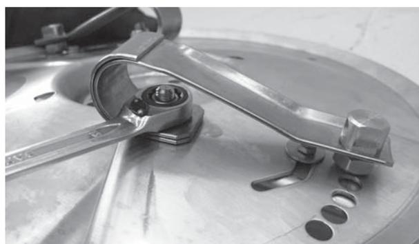
**рисунок 9.30:** Закрепление распорки
