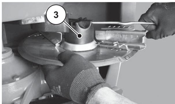
рисунок 8.6: Снимите колпачковую гайку
