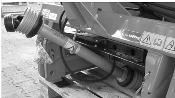
**рисунок 6.34:** Отложить карданный вал и гидравлические шланги
