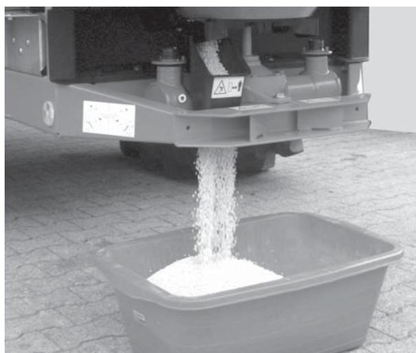
**рисунок 8.8:** Выполнение установки на норму внесения удобрения
