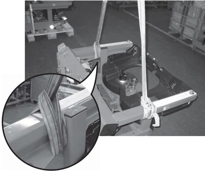
рисунок 6.1: Поднять раму
