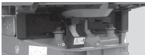
рисунок 8.7: Спускная труба под выпускным отверстием
