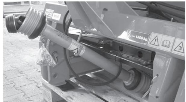
**Figure 6.24 :** Fixation d'arbre de transmission.
