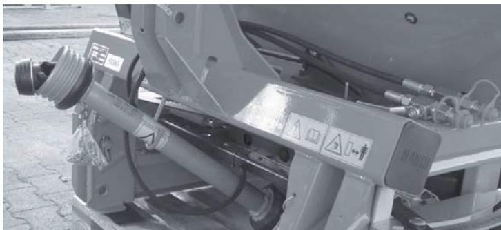
**Figure 6.34 :** Dépose de l'arbre de transmission et des flexibles hydrauliques
