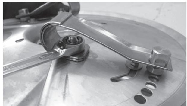
**Figure 9.30** : Fixation des ressorts plats
