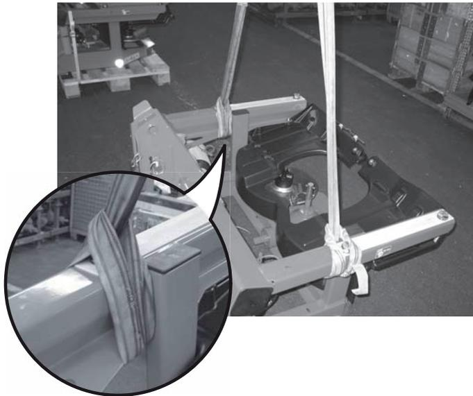
**Figure 6.1 :** Soulever le châssis
