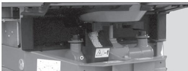
Figure 8.7 : Goulotte de contrôle de débit sous la trappe
