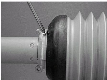
2. Поверните кожух в положение для демонтажа
