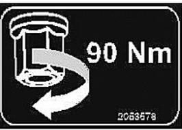
**Момент затяжки закрепление бункера на раме**
