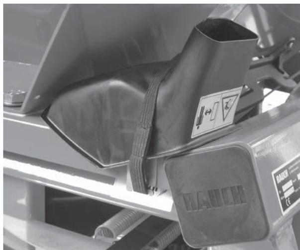
**Figura 7.3:** Scivolo per il test di taratura
