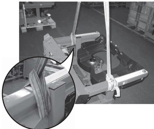
**Figura 5.1:** Sollevamento del telaio
