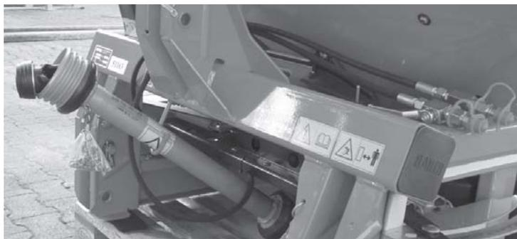
**Figura 5.25:** Deposito dell'albero cardanico e dei tubi flessibili idraulici
