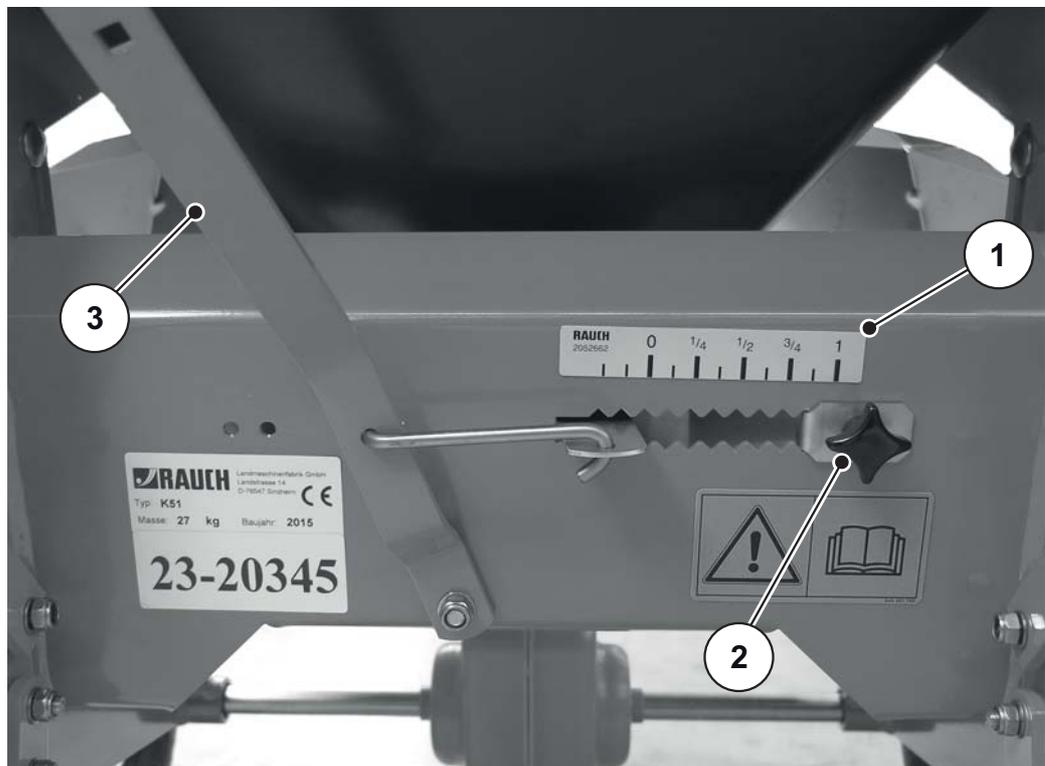
**Bild 7.1:** Skala zur Einstellung der Streumenge
