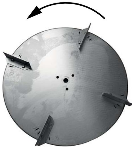
**Bild 7.3:** Drehrichtung der Wurfscheibe
