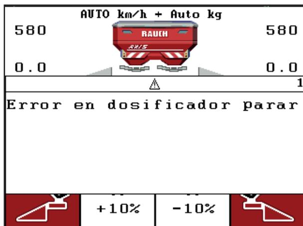
**Imagen 6.1:** Mensaje de alarma (ejemplo: dosificador)
