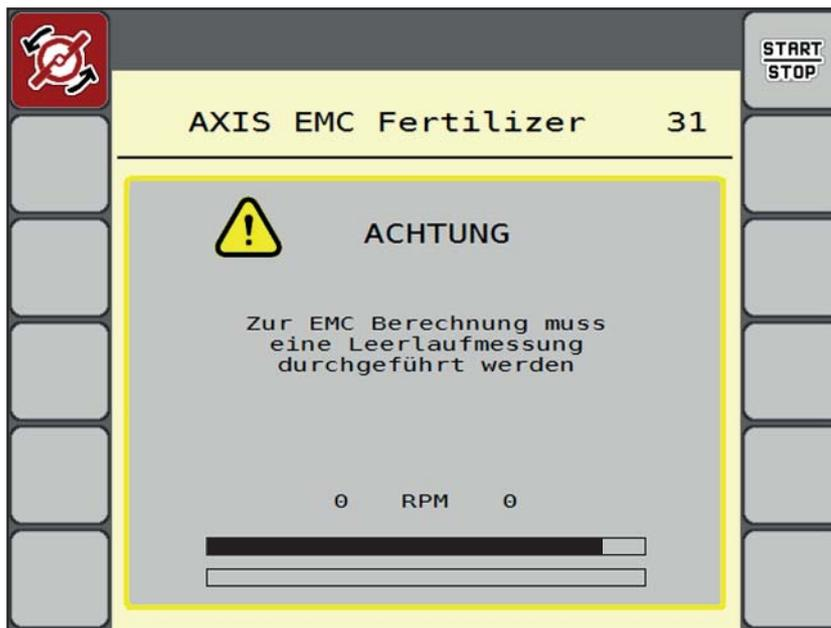
**Bild 5.5:** Alarmanzeige Leerlaufmessung
