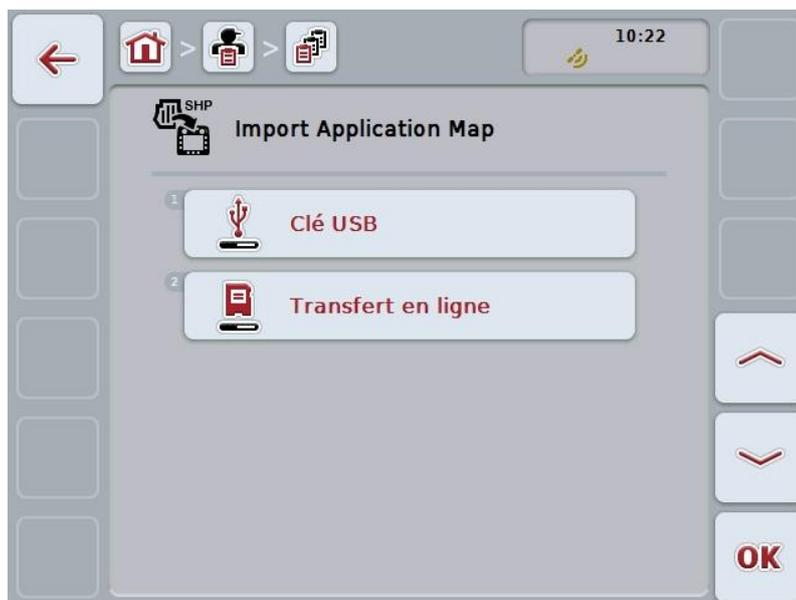
3. Appuyer sur le bouton « Transfert en ligne » ou tourner la molette de défilement jusqu'à ce que le bouton soit marqué en blanc et appuyer ensuite sur la molette de défilement.
