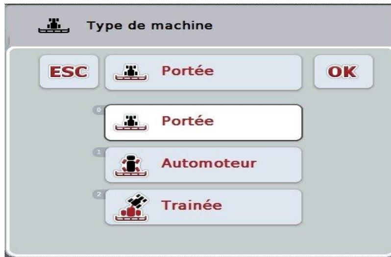
2. Sélectionner le type de machine souhaité dans la liste. Pour cela, appuyer sur *l'écran tactile* sur le bouton portant le type de la machine ou tourner la molette de défilement jusqu'à ce que le bouton soit marqué en blanc et appuyer ensuite sur la molette de défilement.
