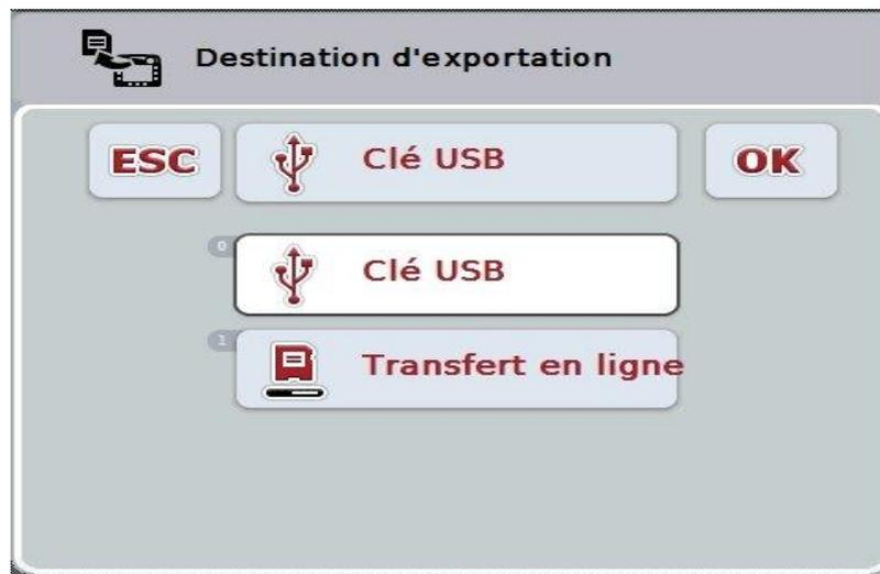
2. Sélectionner « Clé USB » ou « Transfert en ligne ». Pour cela, appuyez sur l'écran tactile sur le bouton portant le nom du mode de transfert souhaité ou tourner la molette de défilement jusqu'à ce que le bouton soit marqué en blanc et ensuite appuyer sur la molette de défilement.
