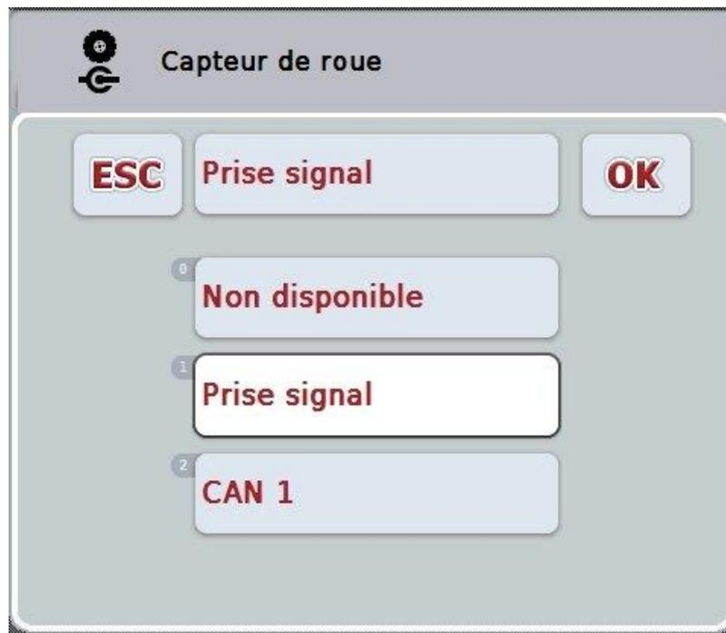
2. Sélectionner la source de signal souhaitée. Pour cela, appuyer sur l'écran tactile sur le bouton avec la source de signal ou tourner la molette de défilement jusqu'à ce que le bouton soit marqué en blanc et appuyer ensuite sur la molette de défilement.
