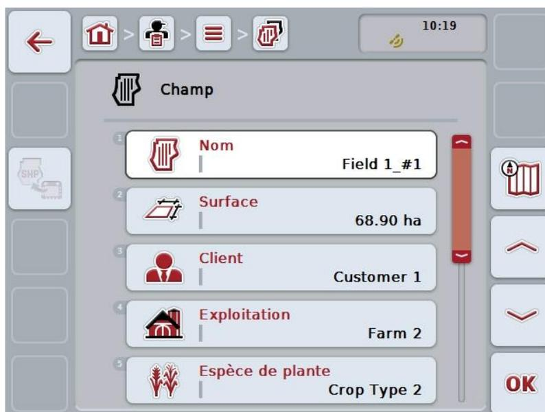
3. Dans le masque de commande, sélectionner le paramètre dont la valeur doit être modifiée. Pour cela, appuyer sur le paramètre de l'écran tactile ou tourner la molette de défilement jusqu'à ce que le bouton soit marqué en blanc et appuyer ensuite sur la molette de défilement. Lorsque le bouton est marqué, vous pouvez également appuyer sur le bouton « OK » (F6).
