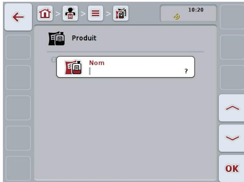
2. Sélectionner tous les paramètres les uns après les autres dans le masque de commande. Pour cela, appuyer sur le paramètre de l'écran tactile ou tourner la molette de défilement jusqu'à ce que le bouton soit marqué en blanc et appuyer ensuite sur la molette de défilement. Lorsque le bouton est marqué, vous pouvez également appuyer sur le bouton « OK » (F6).
