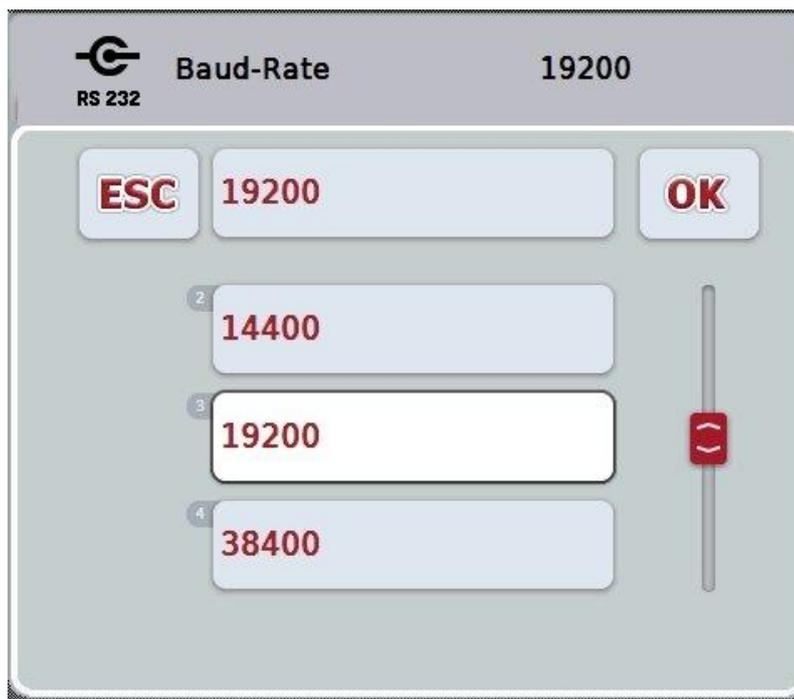
3. Sélectionner le Baud-Rate souhaité dans la liste de sélection. Pour cela, appuyer sur l'écran tactile sur le bouton avec le Baud-Rate ou tourner la molette de défilement jusqu'à ce que le bouton soit marqué en blanc. Ensuite, le Baud-Rate apparaît dans la fenêtre de sélection.
