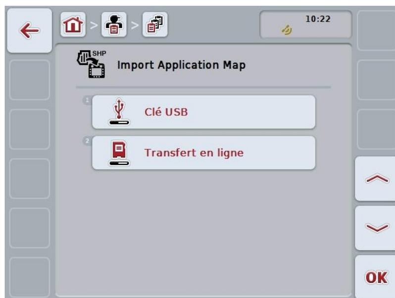
4. Appuyer sur le bouton « Clé USB » ou tourner la molette de défilement jusqu'à ce que le bouton soit marqué en blanc et appuyer ensuite sur la molette de défilement.
