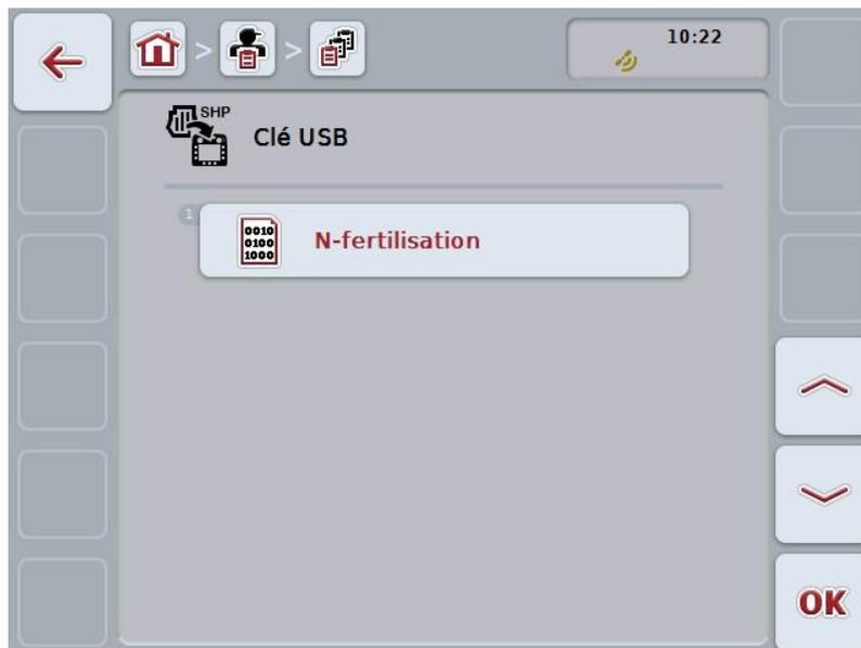
5. Sélectionner la carte d'application qui doit être importée. Pour cela, appuyer sur l'écran tactile sur le bouton avec la carte d'application ou tourner la molette de défilement jusqu'à ce que le bouton soit marqué en blanc et appuyer ensuite sur la molette de défilement ou sur le bouton « OK » (F6).
