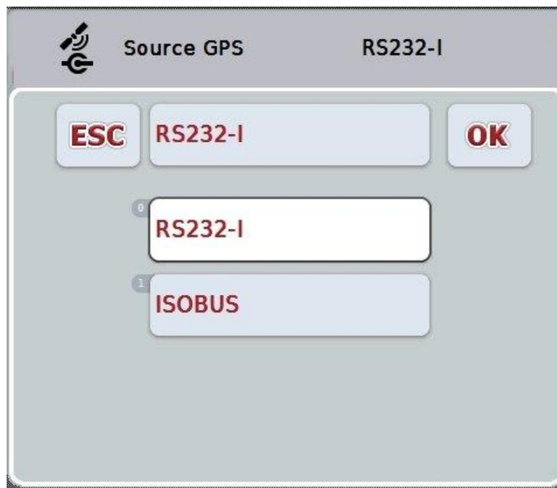
2. Sélectionner la source GPS souhaitée dans la liste de sélection. Pour cela, appuyer sur l'écran tactile sur le bouton avec la source GPS ou tourner la molette de défilement jusqu'à ce que le bouton soit marqué en blanc. Ensuite, la source GPS apparaît dans la fenêtre de sélection.
