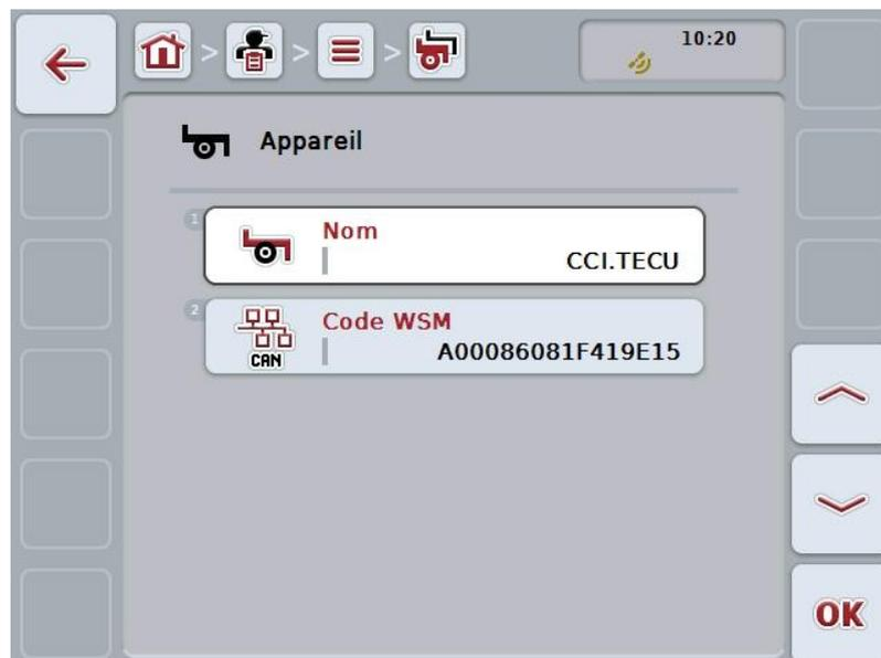
3. Dans le masque de commande, sélectionner le paramètre dont la valeur doit être modifiée. Pour cela, appuyer sur le paramètre de l'écran tactile ou tourner la molette de défilement jusqu'à ce que le bouton soit marqué en blanc et appuyer ensuite sur la molette de défilement.
