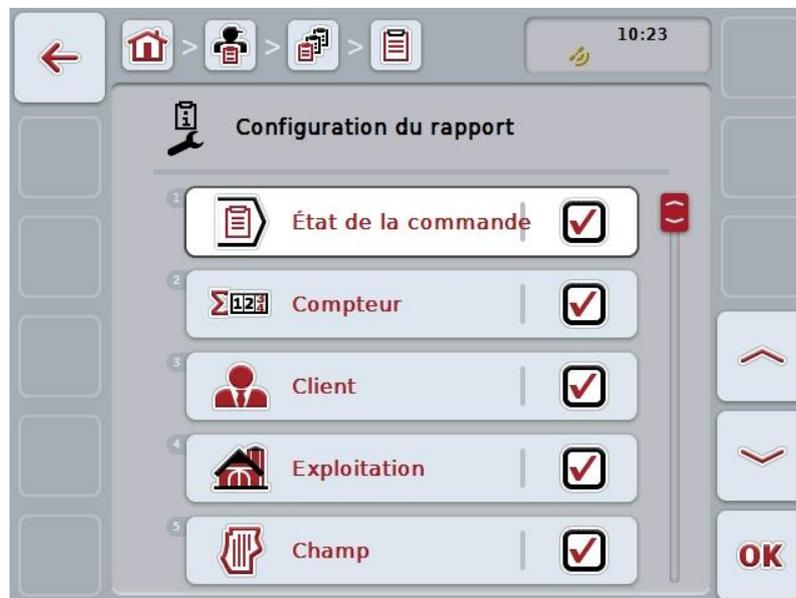
2. Sélectionner les paramètres qui doivent apparaître dans le rapport de tâche. Pour cela, appuyer sur le paramètre de l'écran tactile ou tourner la molette de défilement jusqu'à ce que le bouton soit marqué en blanc et appuyer ensuite sur la molette de défilement. Lorsque le bouton est marqué, vous pouvez également appuyer sur le bouton « OK » (F6).
