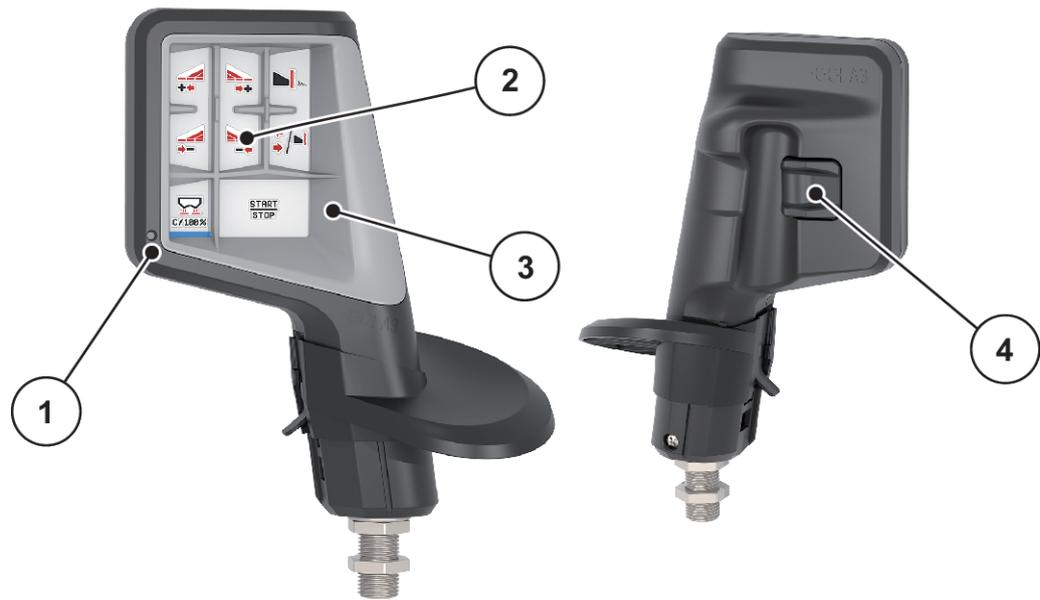
*Ilust. 31: CCI A3 Joystick, parte delantera y trasera*
