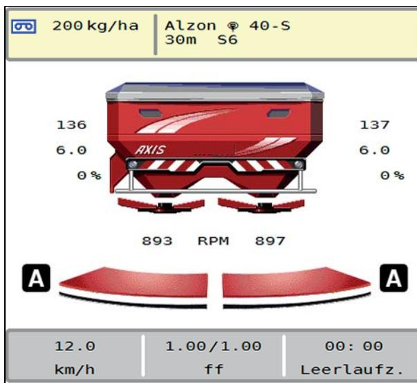
**Imagen 5.11:** Indicador del modo de dispersión en la pantalla de funcionamiento con GPS Control
