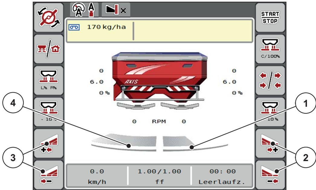
**Imagen 5.5:** Pantalla de funcionamiento de 2 anchuras parciales
