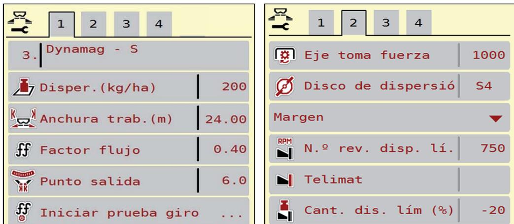
Imagen 4.3: Menú "Ajustes fertilizante" **AXIS-M**, pestañas 1 y 2
