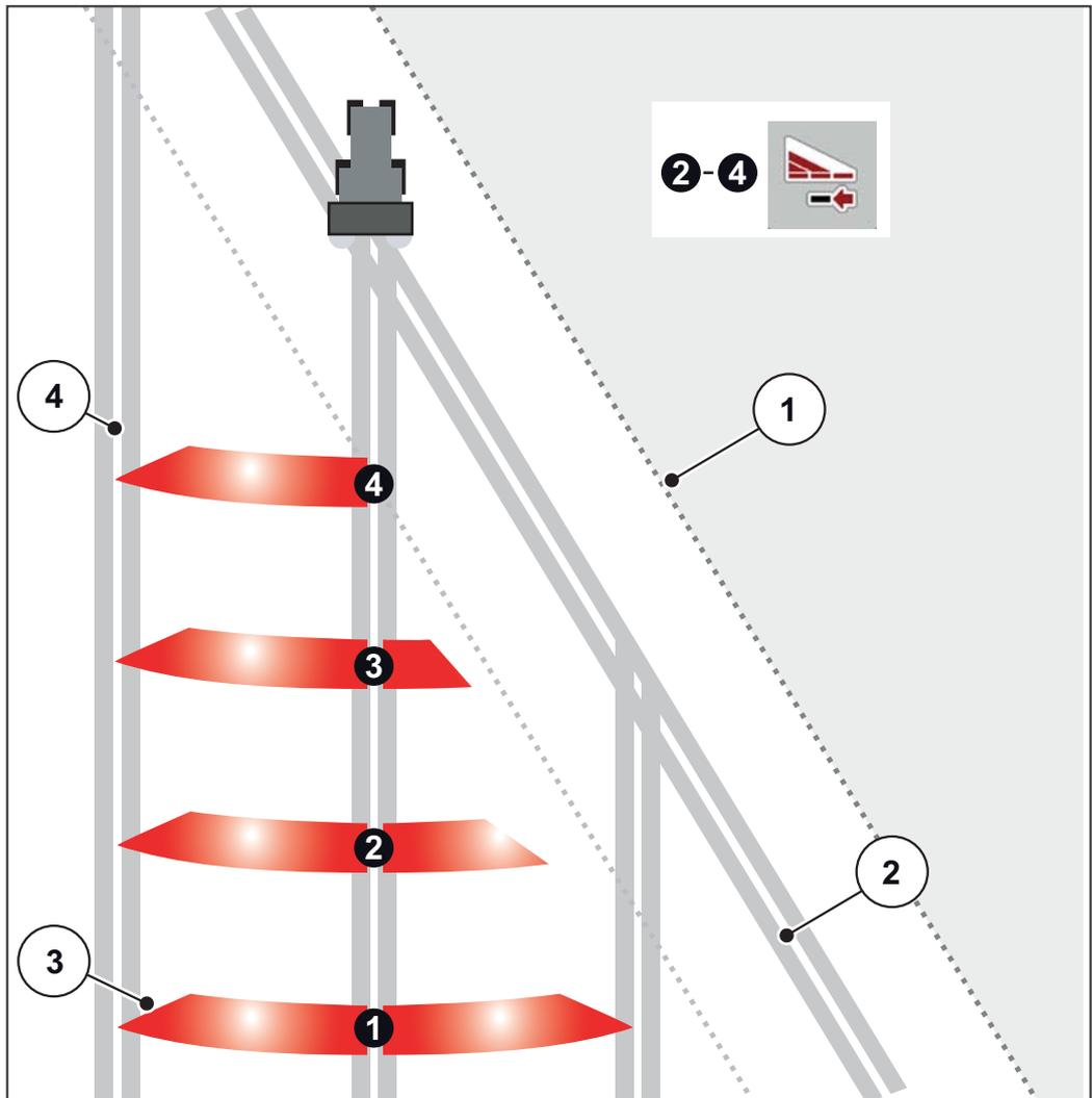
**Imagen 5.4:** Conexión de anchuras parciales automática (AXIS-M 20.2)
