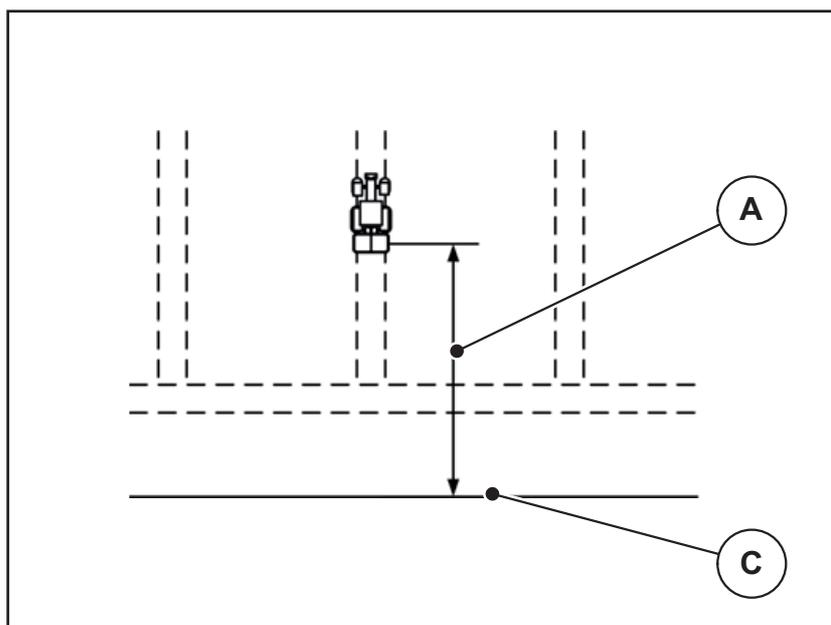
**Imagen 5.12:** Distancia de conexión (en relación con el límite del campo)
