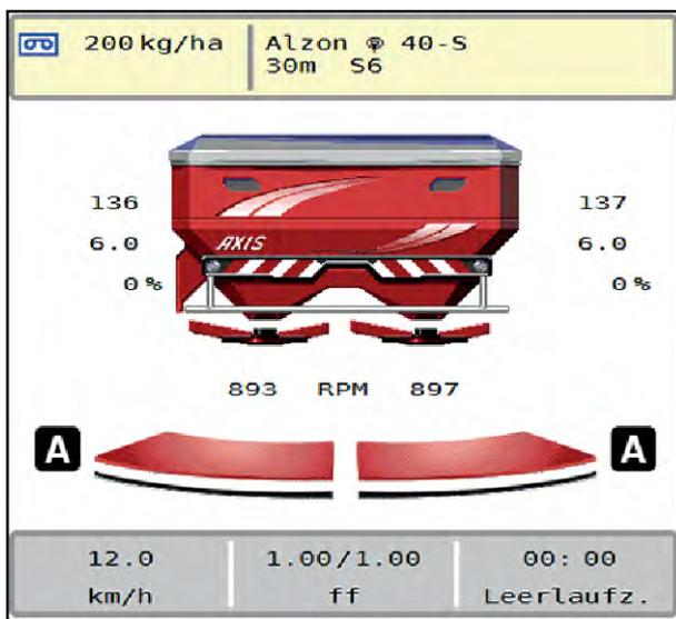
Abb. 47: Anzeige Streubetrieb am Betriebsbild mit GPS Control
