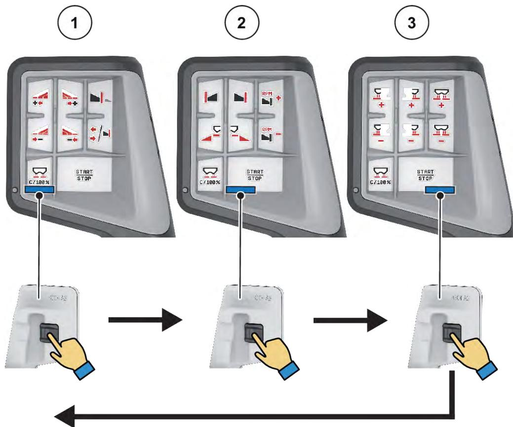
Abb. 32: CCI A3 Joystick, Anzeige Bedienebene
