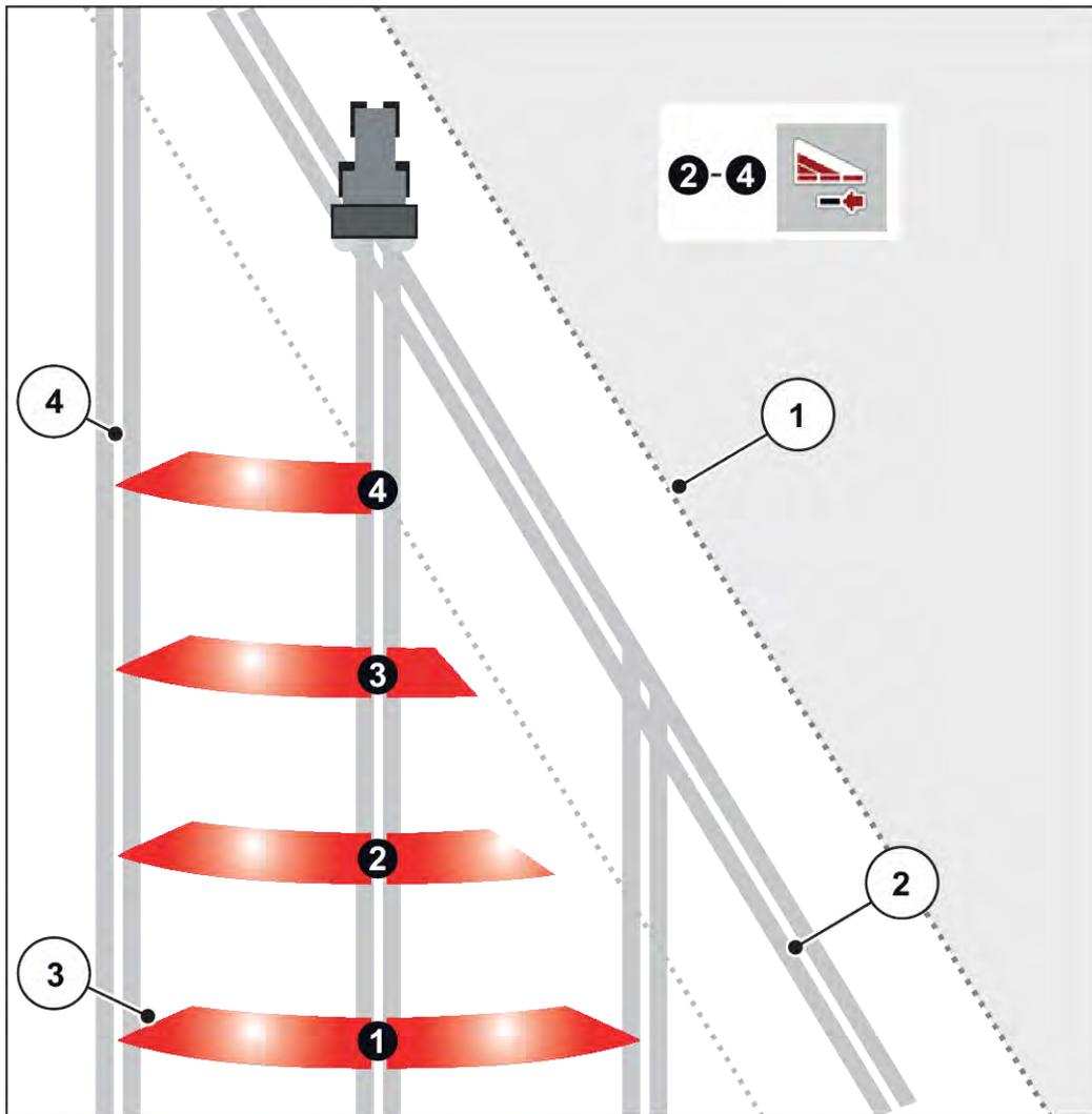
Abb. 40: Automatische Teilbreitenschaltung
