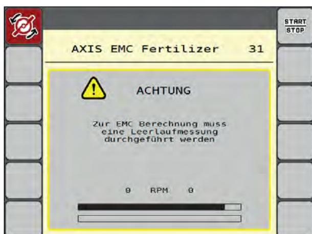
Abb. 44: Alarmanzeige Leerlaufmessung
