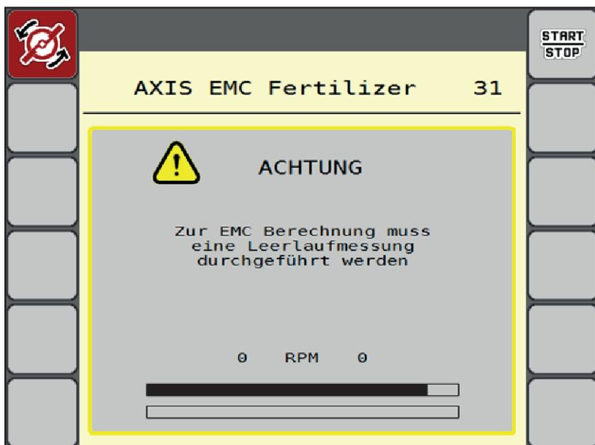
Abb. 43: Alarmanzeige Leerlaufmessung
