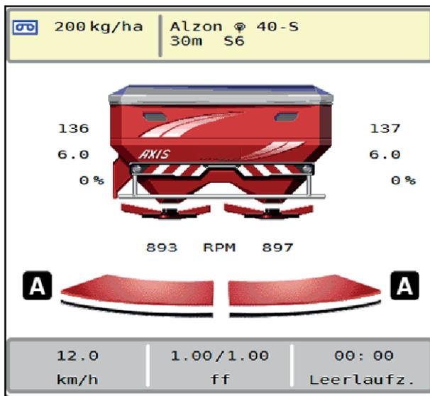
Abb. 46: Anzeige Streubetrieb am Betriebsbild mit GPS Control
