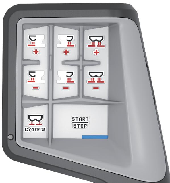
Abb. 34: Tastenbelegung Ebene 3
