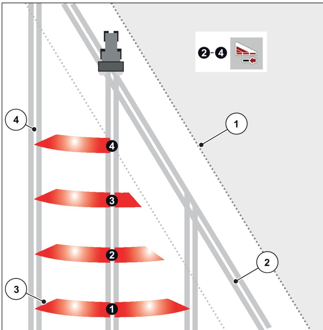
Abb. 39: Automatische Teilbreitenschaltung
