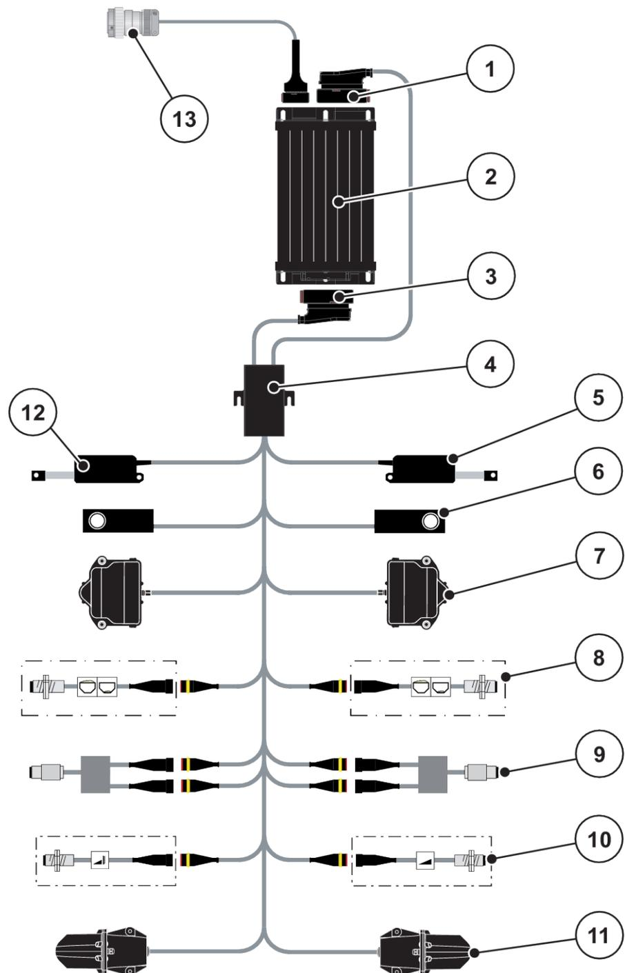
Abb. 8: AXIS-M 30.2 EMC, AXIS-M 50.2: Schematische Anschlussübersicht
