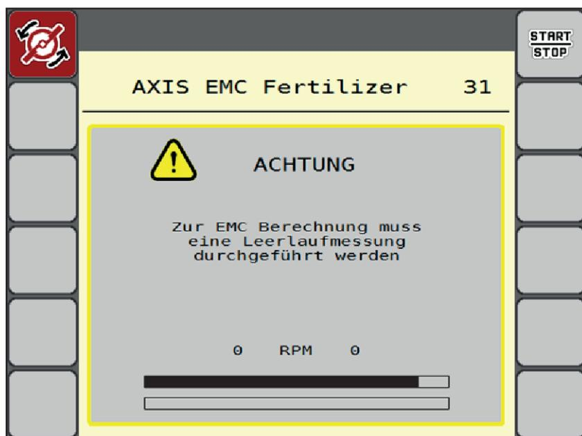
Abb. 44: Alarmanzeige Leerlaufmessung
