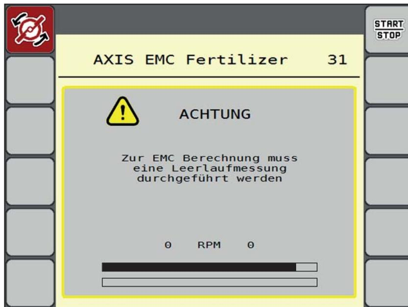
**Bild 5.8:** Alarmanzeige Leerlaufmessung
