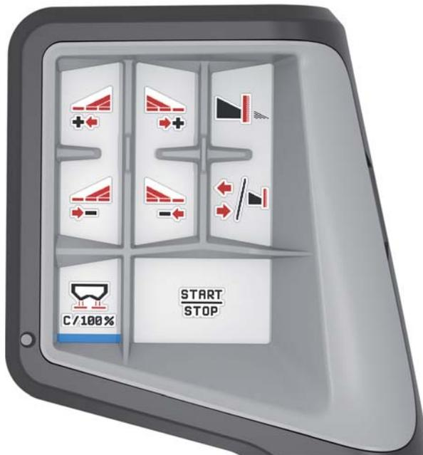
Bild 4.23: Tastenbelegung Ebene 1
