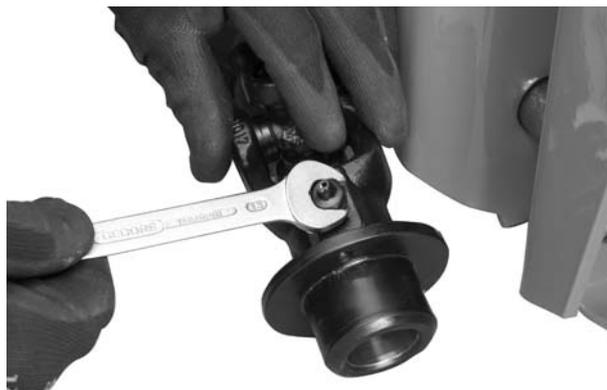
Imagem 2: Soltar o bocal de lubrificação
