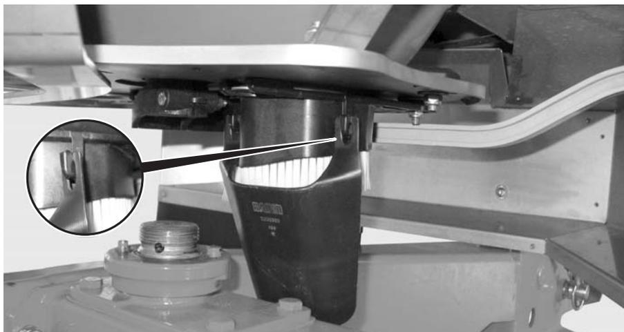
Imagem 11: Suspender o deslizador do teste de rotação
