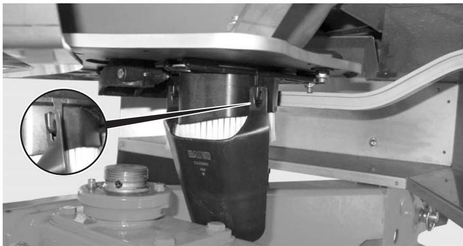
**Imagem 18:** Suspender o deslizador do teste de rotação
